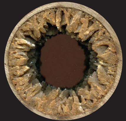
สิ่งอุดตันแบบแข็ง กากตะกอน ตะกอนยูริค หินปูน
