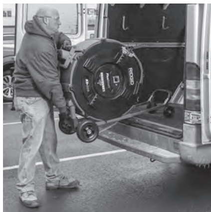
Figura 17 – Colocación de la máquina en el camión
