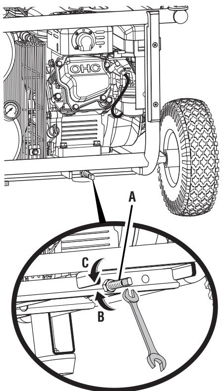
A - Belt tensioner bolt (boulon de tension de courroie, perno de tensión de la correa)
