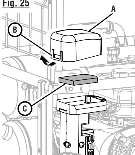
A - Engine air filter cover (couvercle du filtre à air du moteur, tapa del filtro de aire del motor)
