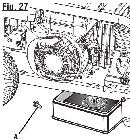
A - Oil drain plug (huiler le bouchon d'égout, tapón de drenaje del aceite)
