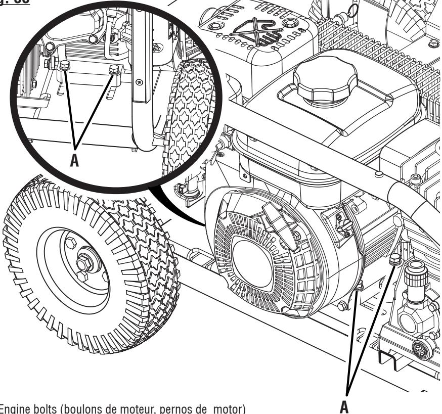
A - Engine bolts (boulons de moteur, pernos de motor)
