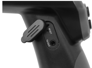
Figura 9 – Enchufe hembra TV-OUT y botón de re-ajustar
