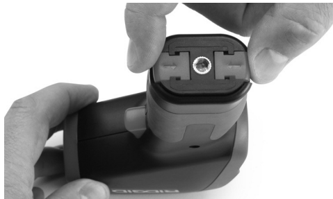
Figure 4 – Retrait du porte-pile
