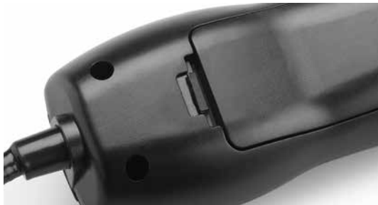
Figure 5 – Chiusura del coperchio del vano batterie
