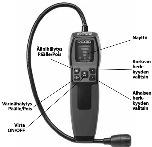
Kuva 2 – micro CD-100 -laitteen osat
