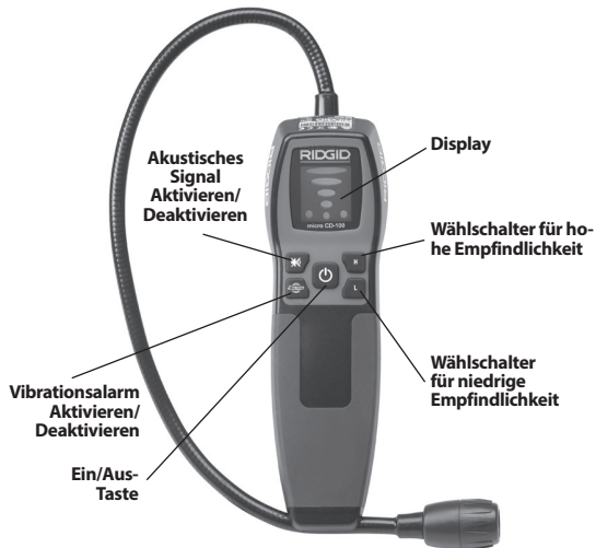
Abbildung 2 – Teile des micro CD-100
