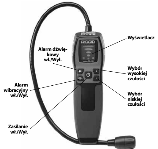
Rysunek 2 – Części micro CD-100
