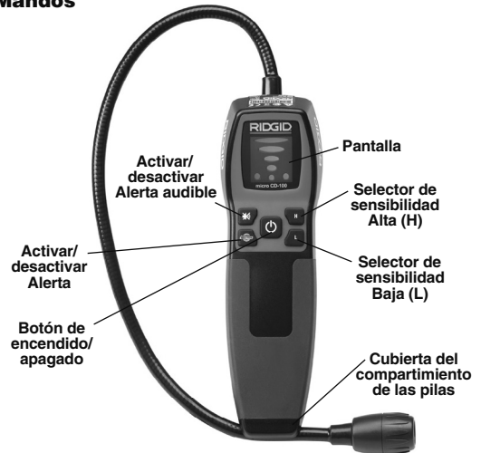
Figura 2 – Piezas y botones del micro CD-100
