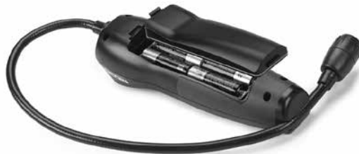
Rysunek 4 – Zdejmowanie pokrywy komory baterii
