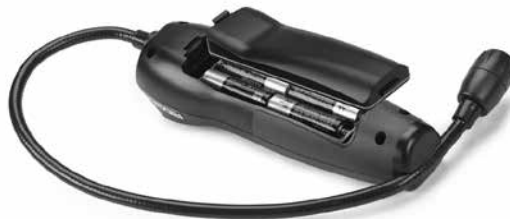
Figura 4 – Remoção da tampa do compartimento das pilhas
