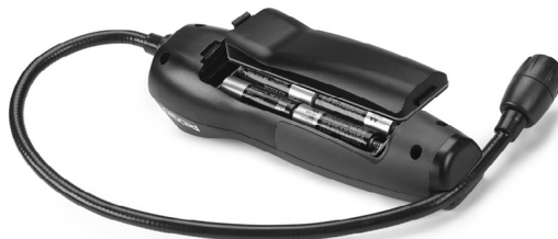
Figura 4 – Extracción de la cubierta del compartimiento de las pilas
