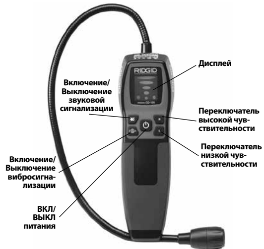
Рис. 2 – Детали прибора micro CD-100
