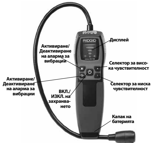
Фигура 2 – Части на micro CD-100
