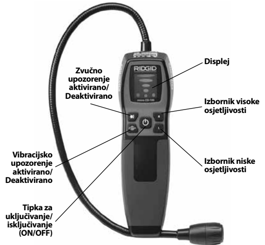
Slika 2 – Dijelovi uređaja mikro CD-100
