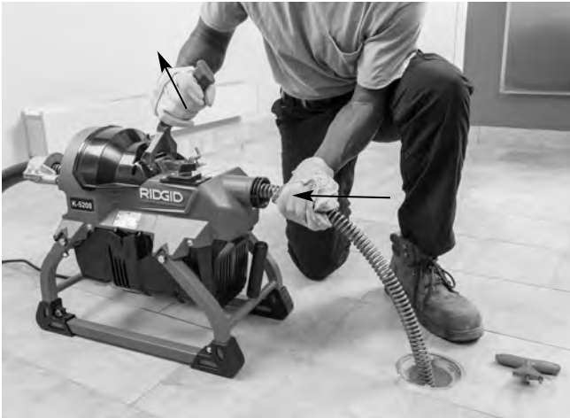
Figura 14 B – Con el embrague suelto, sin que esté girando el cable, se mete el cable dentro de la máquina
