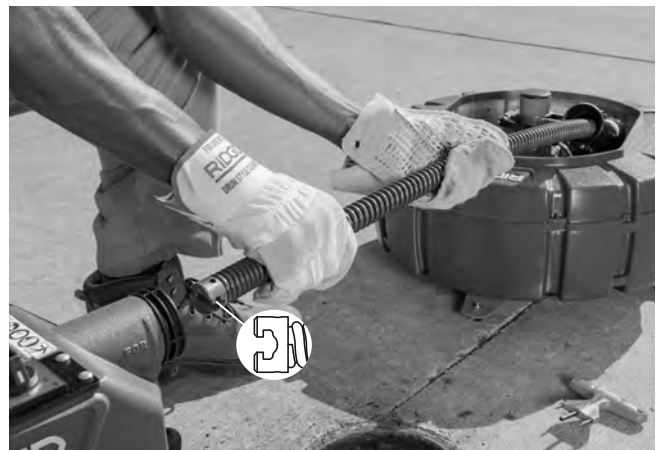
Figure 7 – Introduction du câble via l'avant de la machine
