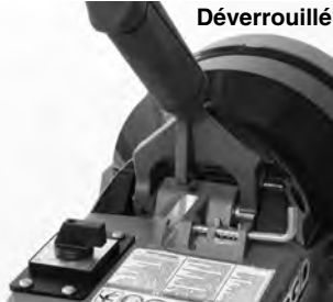
Figure 4 – Libération du levier d'embrayage
