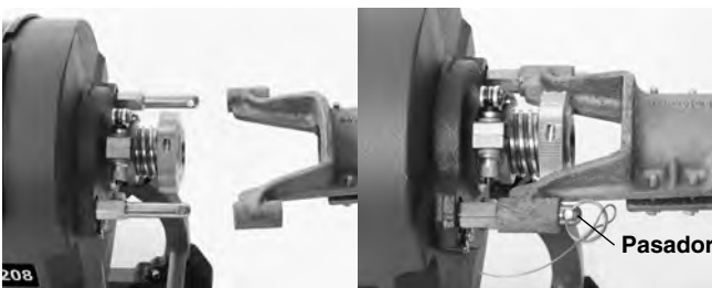
Figura 6 – Conexión de la manguera guía trasera
