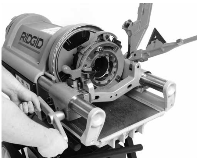
Slika 23 – Narezivanje cijevi (prikazana narezna glava 714)
