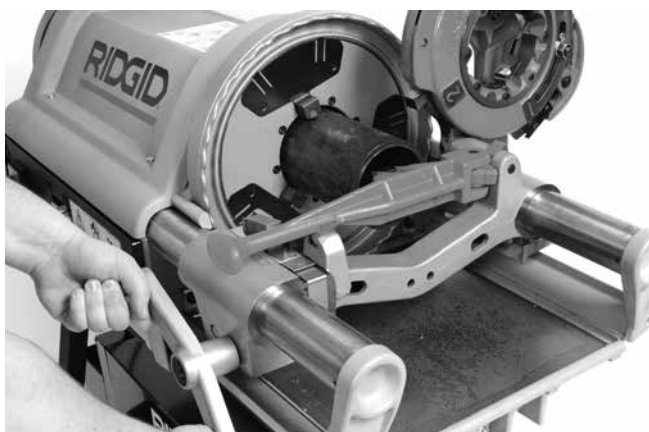
Slika 22 – Povrtanje cevi s povrtalnikom
