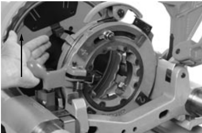
Figura 16 – Cierre del cabezal de terrajas con retroceso
