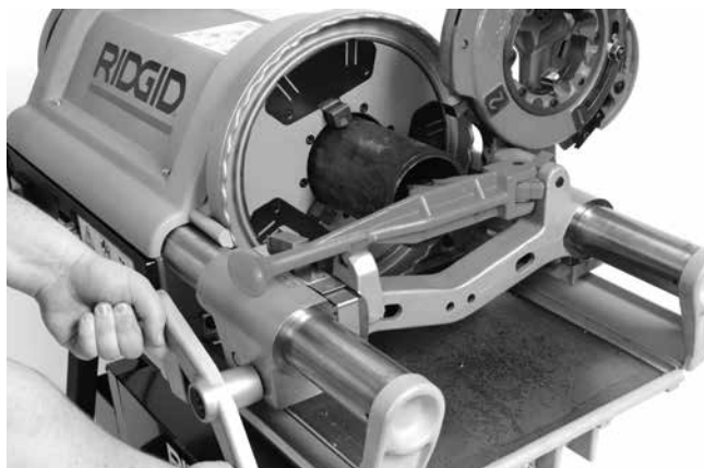
22-сурет – Құбырды үңгішпен үңгіштеу
