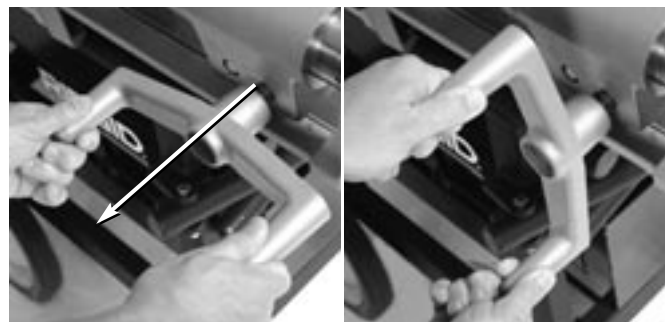
Figure 20 – Réglage du volant du chariot
