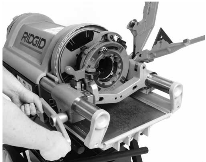
Abbildung 23 – Schneiden von Rohrgewinden (Schneidkopf 714 abgebildet)
