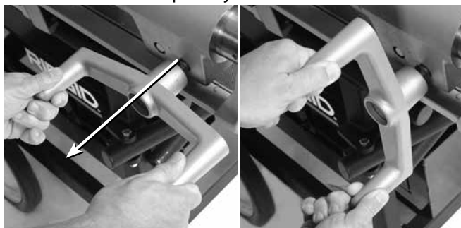
Slika 20 – Podešavanje kola nosača
