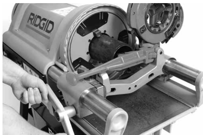
Slika 22 – Proširivanje cijevi skidačem srha
