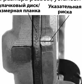
Рис. 14 – Настройка размера резьбы
