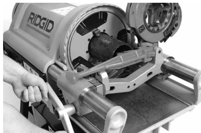
Obrázek 22 – Odhrotování trubky pomocí odhrotovače
