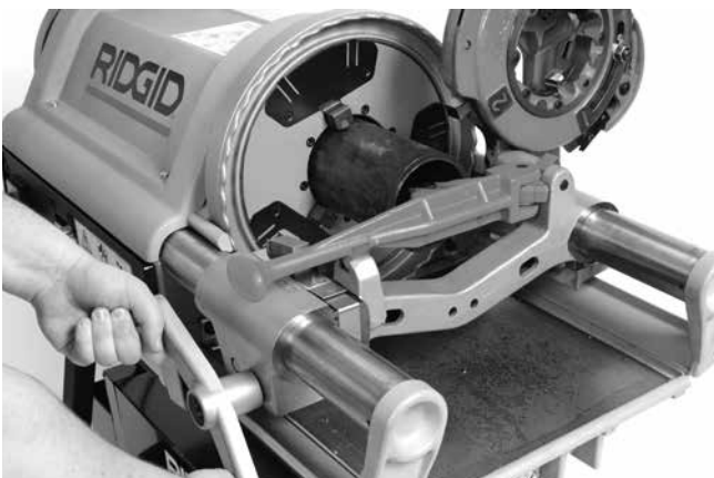
Εικόνα 22 – Ξύσιμο του σωλήνα με ξύστρα
