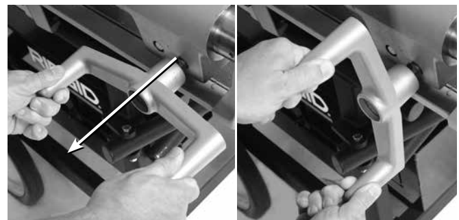
Figur 20 – Justering av sledehåndhjul
