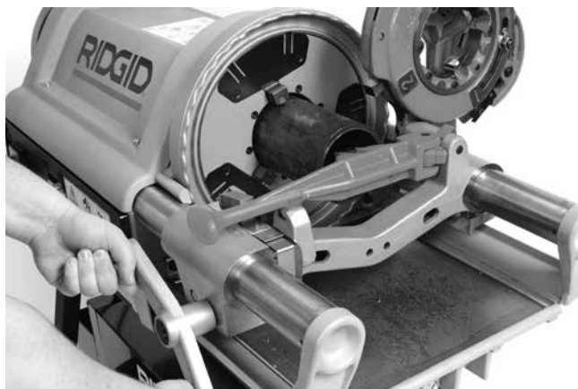
Figura 22 – Alesatura del tubo con l'Alesatore
