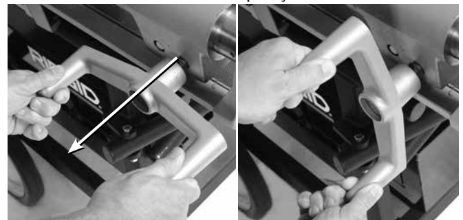
Figura 20 – Ajuste da Manivela da Guia
