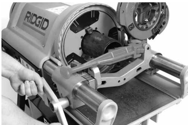
22. ábra – Cső sorjázása a sorjázóval
