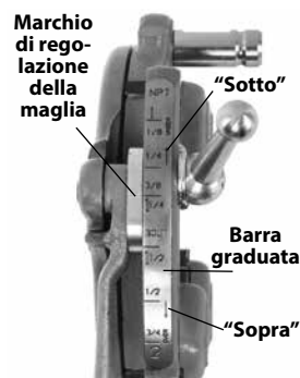
Figura 6 - Regolazione della dimensione della filettatura
