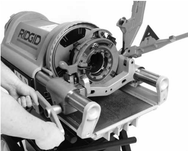
Figura 23 – Filettatura del tubo (Testa portapettini 714 mostrata)
