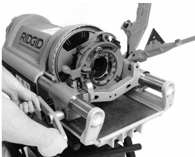
Εικόνα 23 – Ελικोटόμηση σωλήνα (Εικονίζεται η φιλιέρα 714)
