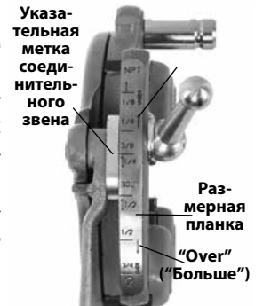
Рис. 6 – Настройка размера резьбы
