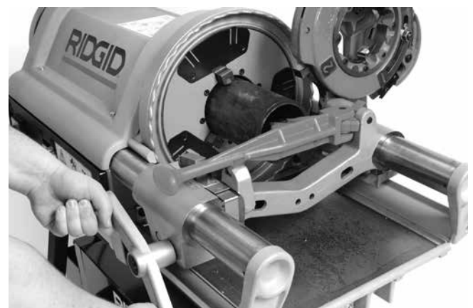
Abbildung 22 – Fräsen des Rohrs mit dem Innenrohrfräser
