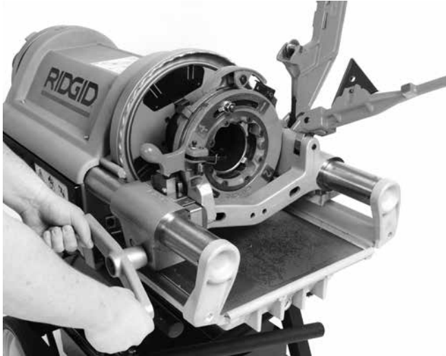
Figura 23 – Tubo de Roscagem (Cabeça de Roscar 714 mostrada)
