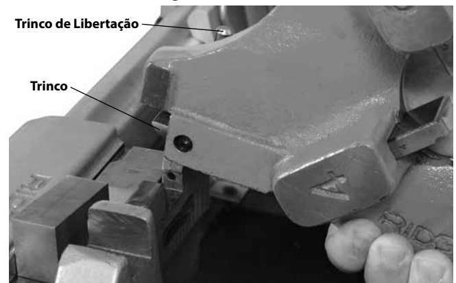
Figura 24 – Fixe a cabeça de Roscar do Lado Esquerdo
