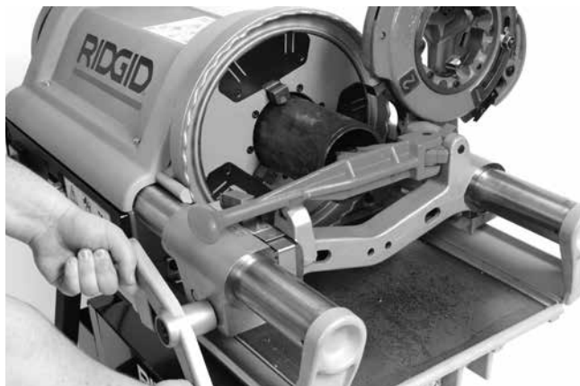
Slika 22 – Razvrtnje cevi pomoću razvrtača
