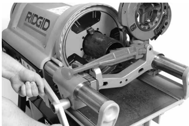
Rys. 22 – Rozwiercanie rur rozwiertakiem
