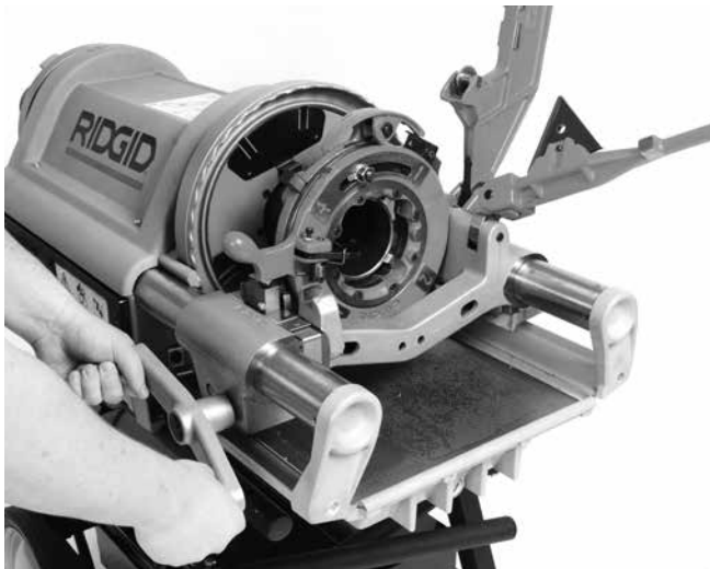
Slika 23 – Narezivanje navoja na cev (prikazana je narezna glava 714)
