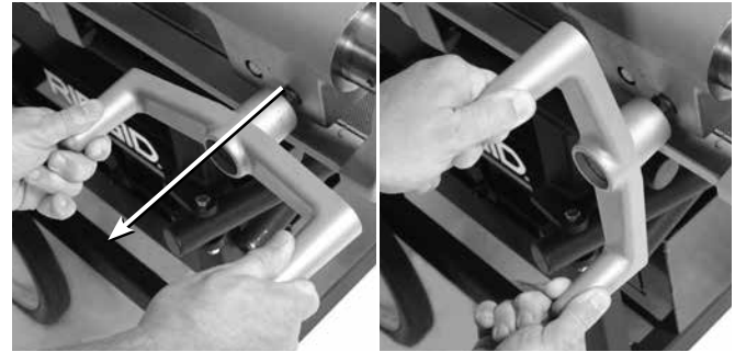
Şekil 20 – Taşıyıcı El Çarkı Ayarı
