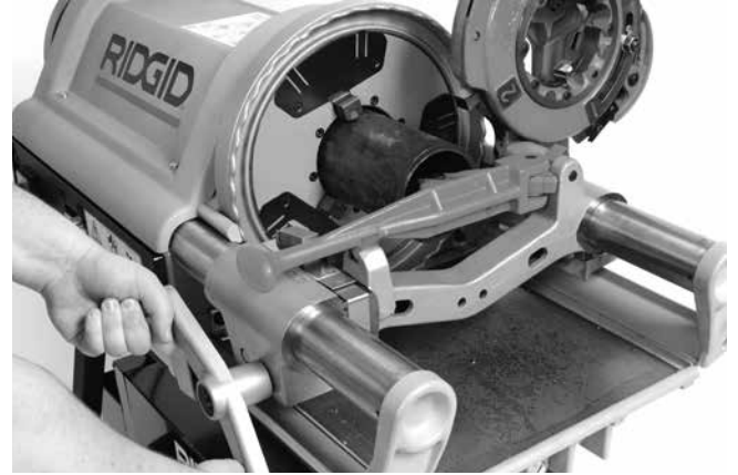
Şekil 22 – Raybalama Makinesiyle Boru Raybalama
