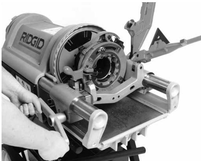
Kuva 23 – Putken kierteitys (kuvassa kierrepää 714)
