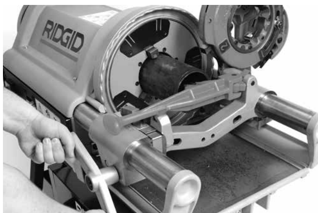
Figura 22 – Alezare țeavă cu alezorul
