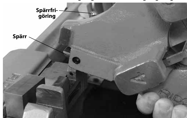
Figur 24 – Låsning på vänstergängat huvud
