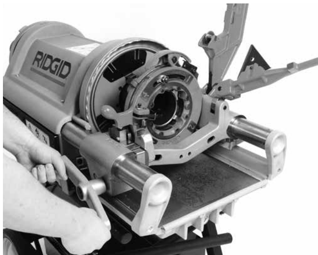
Рис. 23 – Нарезание резьбы на трубе (показана резьбонарезная головка 714)
