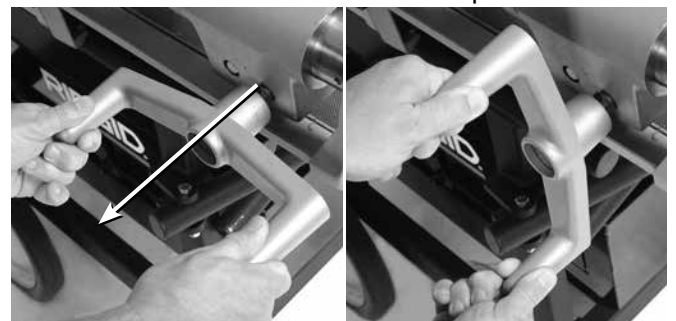
Figura 20 – Regolazione del volantino del carrello
