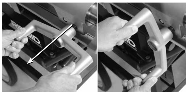
20-сурет – Күймеше айналғысын реттеу
