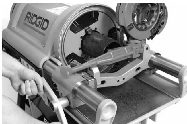
Рис. 22 – Зенкование трубы с использованием зенковки
