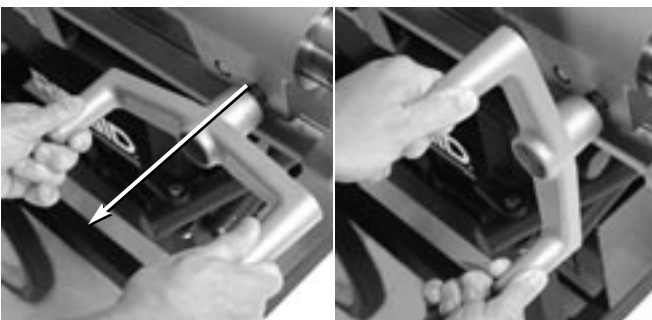
Figura 20 – Ajuste del volante del carro
