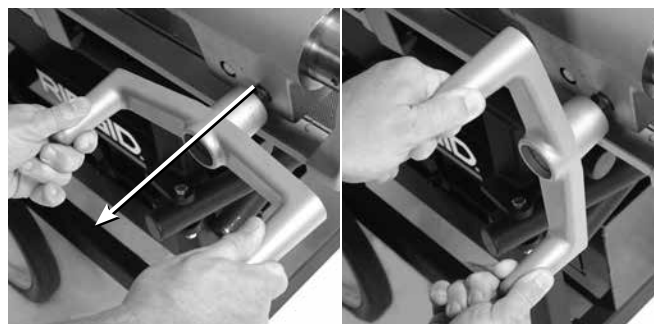
Figuur 20 – Slede verstellen met handwiel
