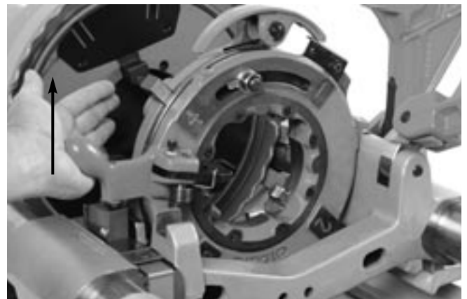
Figure 16 – Fermeture de la tête de filière rétractable
