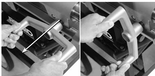
Slika 20 – Nastavitev ročnega kolesa nosilca
