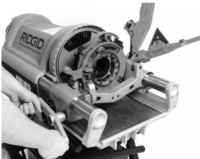
Figur 23 – Gjenging av rør (714 gjengebakkeholder vist)
