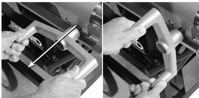
Figur 20 – Justering af håndhjul til slæde
