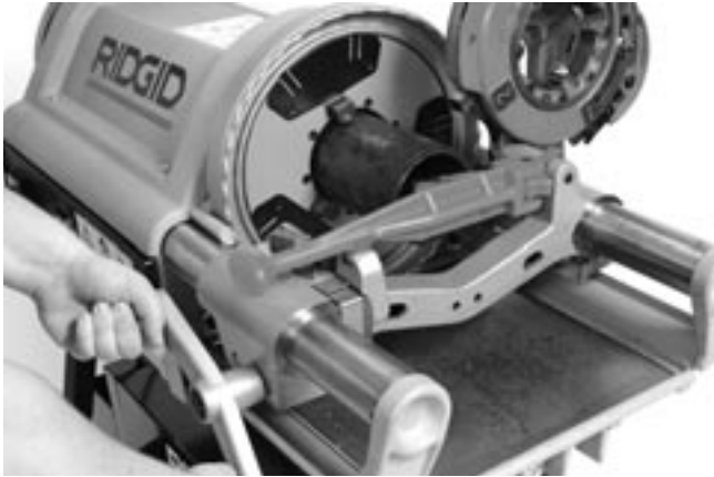
Figura 22 – Escariado de un tubo con el escariador
