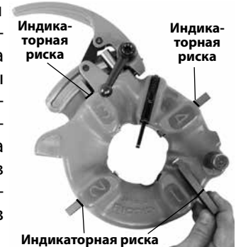
Рис. 9 – Вставка резьбонарезных гребенок
