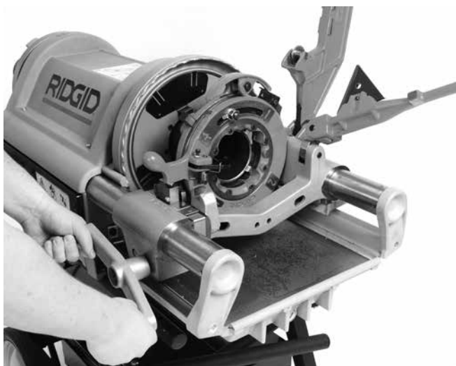
Figur 23 – Gevindskæring af rør (skærehoved 714 vist)
