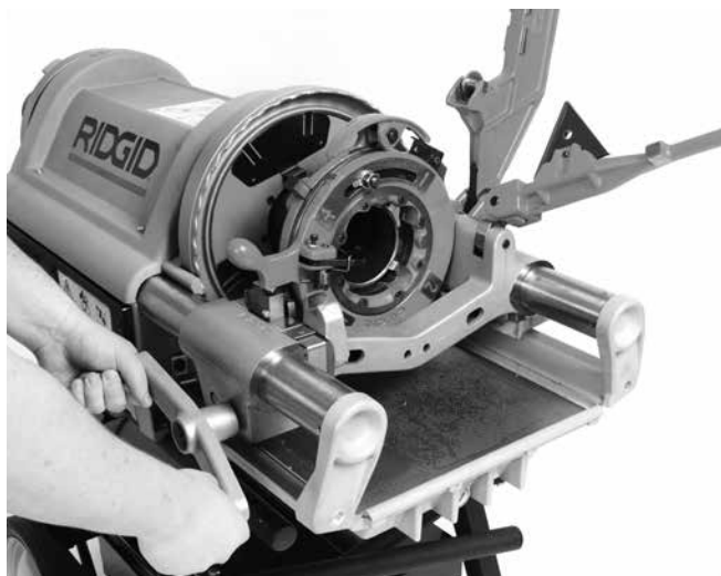
Obrázok 23 – Závítovanie rúry (zobrazená je závitorezná hlava 714)
