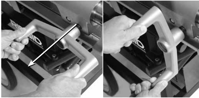
Abbildung 20 – Einstellen des Vorschub-Handrades
