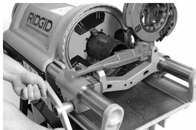
Figur 22 – Fräsa rör med rörfräs
