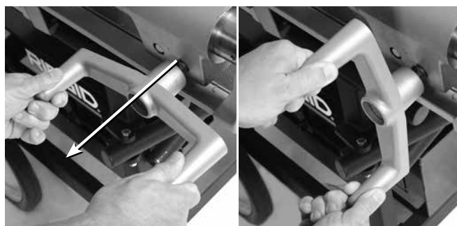
Obrázek 20 – Seřízení ruční kličky pojezdu
