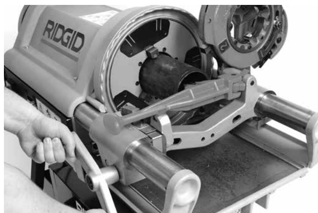
Figur 22 – Fræsning af rør med fræser
