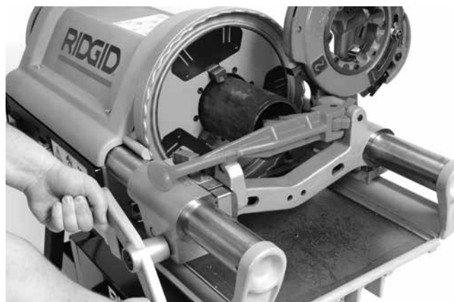
Obrázok 22 – Vystruhovanie rúry výstružníkom
