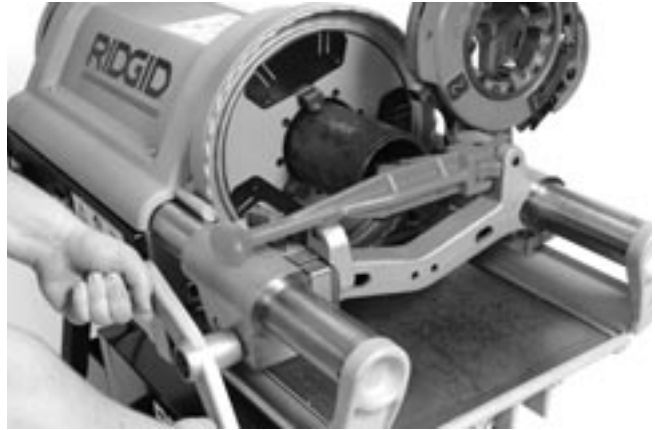
Figure 22 – Alésage du tuyau
