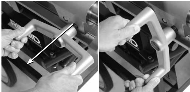
Рис. 20 – Регулировка положения ручного маховичка каретки
