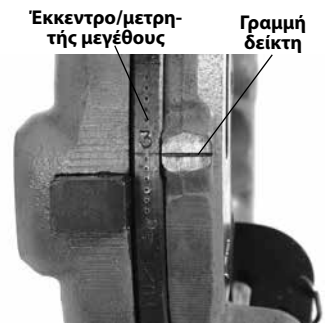
Εικόνα 14 – Ρύθμιση μεγέθους σπειρώματος
