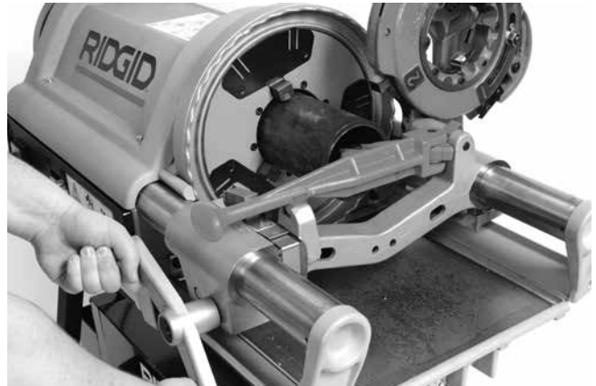
Figura 22 – Escarear Tubo com Escareador
