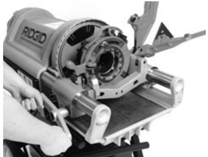
Figura 23 – Roscado de un tubo (se muestra un cabezal de terrajas 714)
