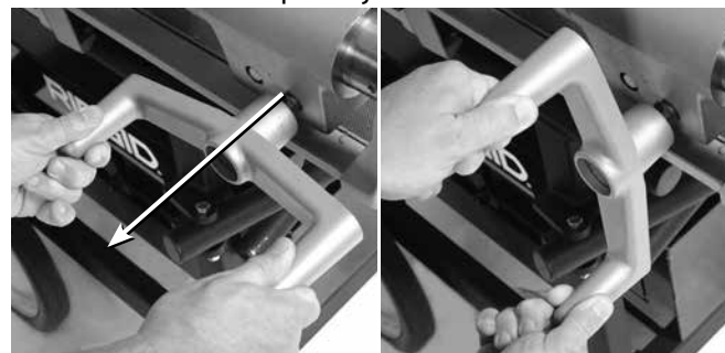
Slika 20 – Podešavanje ručnog točka klizača
