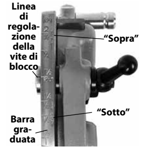
Figura 10 – Regolazione della dimensione della filettatura
