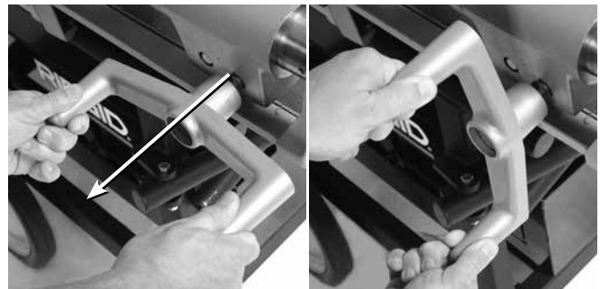
Kuva 20 – Kelkan käsipyörän säätäminen
