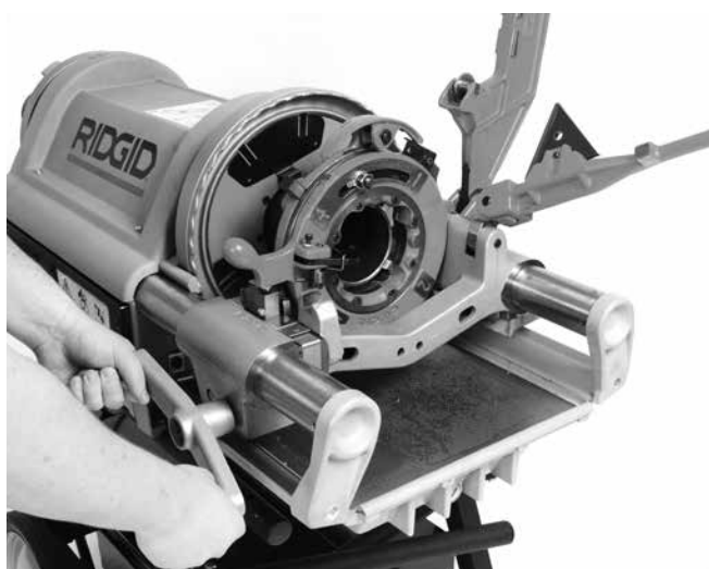
Obrázek 23 – Řezání závitů na trubce (zobrazena závitořezná hlava 714)
