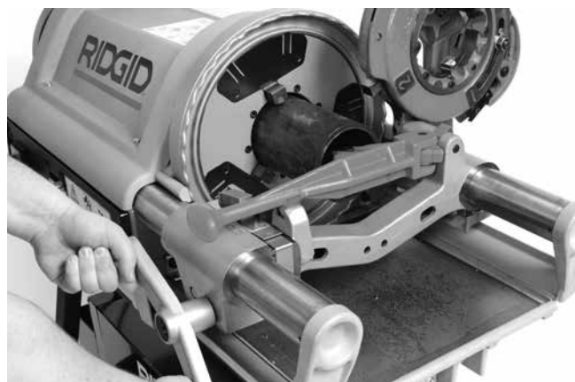
Kuva 22 – Putken jyrsiminen jyrsimellä
