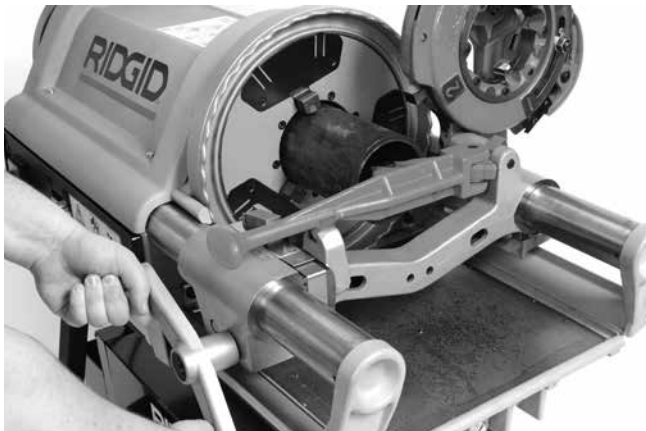
Figuur 22 – Pijp ruimen met ruimer
