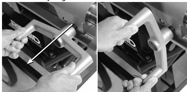
Figur 20 – Justera vagnens handhjul
