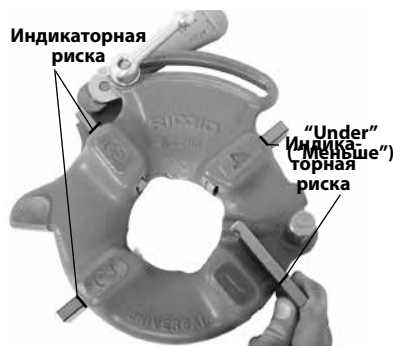
Рис. 5 – Вставка резьбонарезных гребенок
