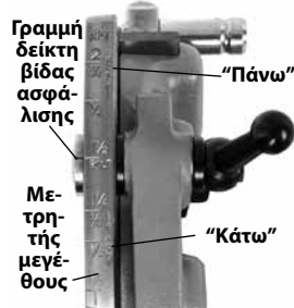
Εικόνα 10 – Ρύθμιση μεγέθους σπειρώματος
