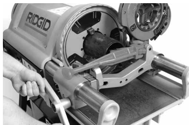
Figur 22 – Avgrade rør med avgrader
