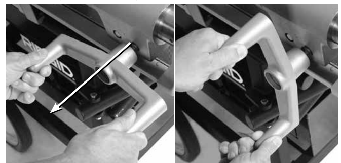
Rys. 20 – Regulacja koła ręcznego karetki
