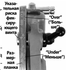
Рис. 10 – Настройка размера резьбы
