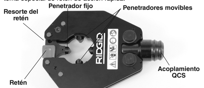
Figura 1 – Cabezal engarzador 4P-6 4PIN, sin terrajas (versión intercambiable)
