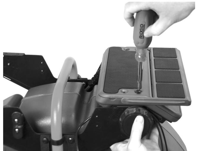
Figura 13 – Montaje de la plataforma derecha
