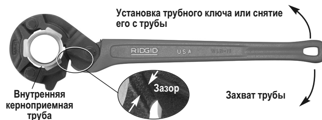
Рис. 2 – Работа с колоночным трубным ключом
