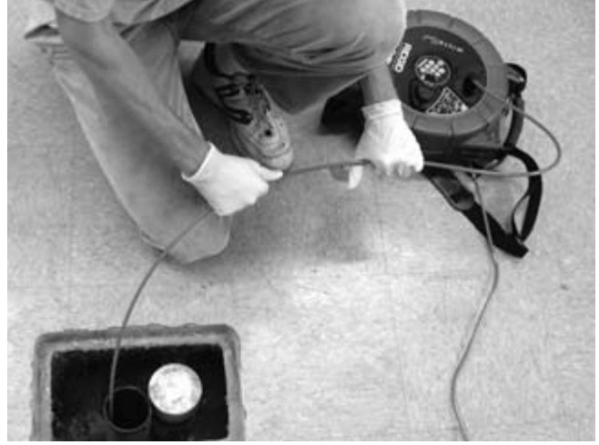
Şekil 29 – Kabloyu şekilindeki gibi tamburdan fazla çıkarmak itirken kablounun kıvrılmasına neden olabilir
