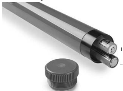
Figur 4 – Udskiftning af batterier
