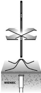
Rys. 9 – Sygnał w lokalizacji precyzyjnej
