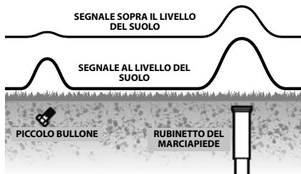
Figura 6 – Sollevamento del localizzatore per minimizzare i segnali indesiderati
