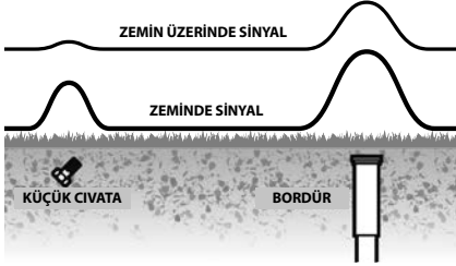
Şekil 6 – Manyetik Dedektörün Yerden Yükseltilmesi İstenmeyen Sinyalleri En Az İndirir
