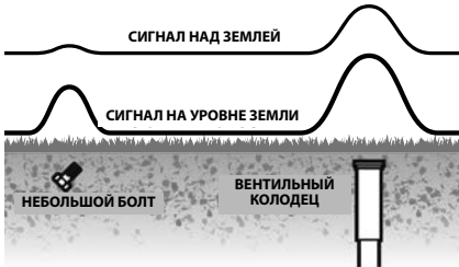
Рис. 6 – Подъем трассоискателя уменьшает сигналы-помехи
