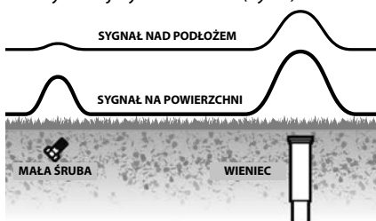
Rys. 6 – Podniesienie lokalizatora minimalizuje niepożądane sygnały
