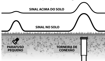
Figura 6 – Elevar o Localizador Minimiza os Sinais não Desejados
