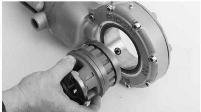
**Figura 4 – Instalar cabeças de rosca no Propulsor 700**
