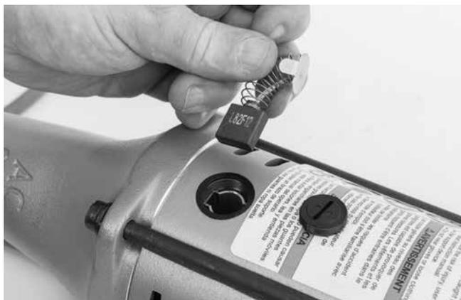
Rysunek 13 – Montaż szczotek
