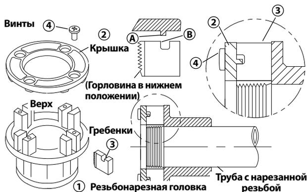
**Рис. 12 – Установка гребенок в резьбонарезную головку**
