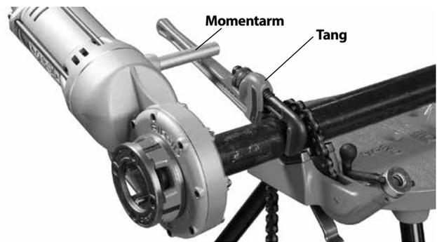
**Figur 7 – Gevindskæring med rørtang som støttearm**
