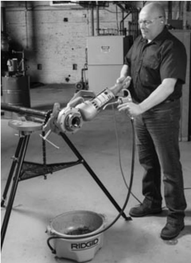
Figura 9 – Roscado de un tubo
