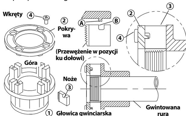
Rysunek 12 – Zakładanie noży do głowicy gwinciarskiej
