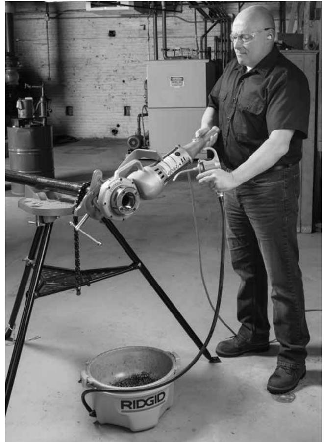
**Рис. 9 – Нарезание резьбы на трубе**
