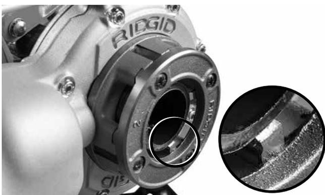
**Рис. 10 – Торцы трубы вровень с кромкой резьбонарезных гребенок**
