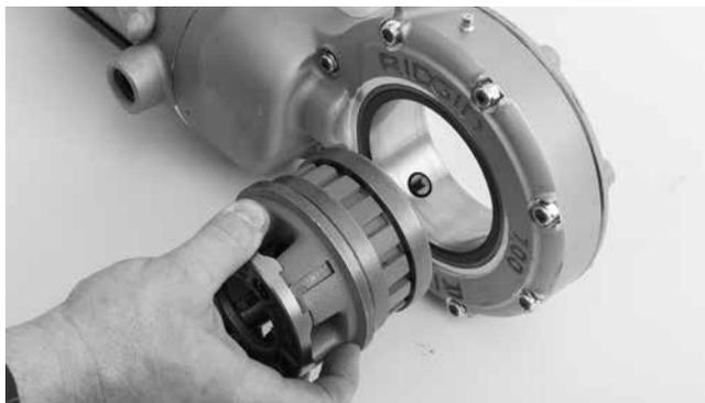
**Obrázok 4 – Inštalácia závitorezných hláv do elektrického pohonu 700**
