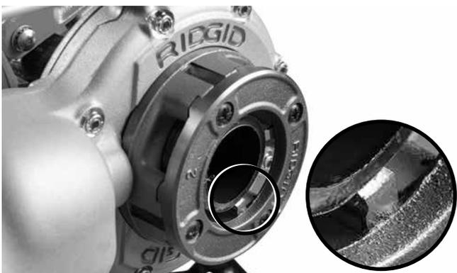
**Figur 10 – Röret i linje med gängbackarnas kant**
