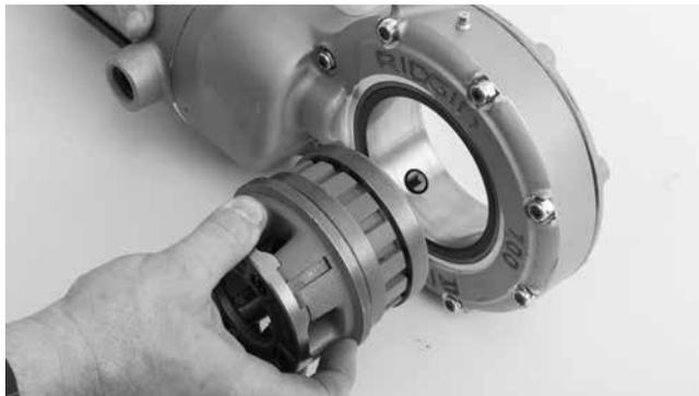
**Obrázek 4 – instalace závitorežných hlav do elektrické závitnice 700**
