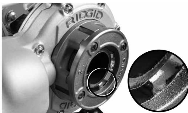
**Obrázek 10 – trubka zarovnaná s okrajem řezných matic**
