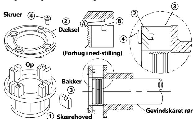
Figur 12 – Montering af bakker i gevindskærehoved
