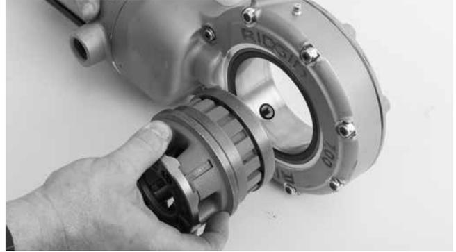
**Şekil 4 – Pafta Kafalarının 700 Elektrikli El Paftasına Takılması**
