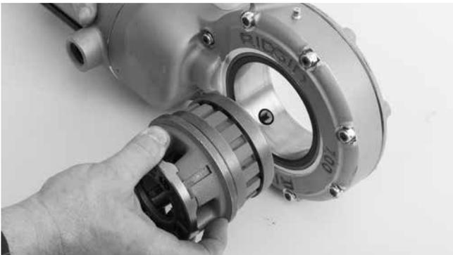
**Kuva 4 – Kierrepäiden asennus 700-käyttölaitteeseen**
