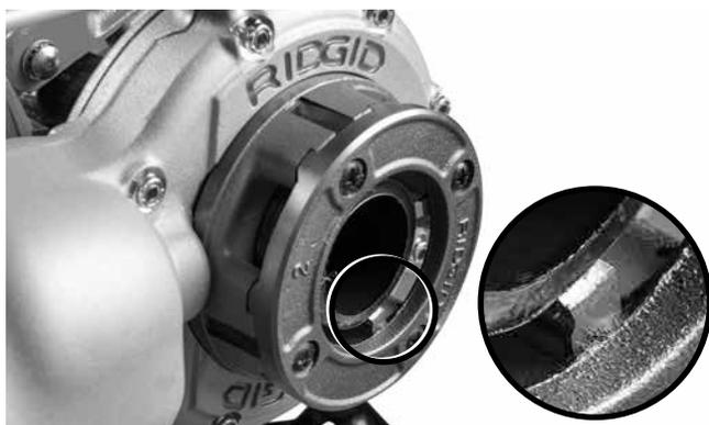
**Figur 10 – Rør i niveau med kanten på bakkerne**
