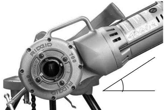
**Kuva 6 – Tukivarsi sijoitettuna ja 700-käyttölaite hieman vaakatason yläpuolella**
