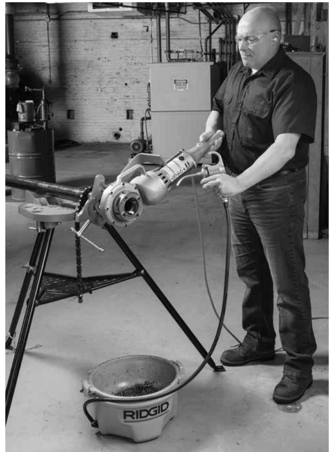
**Figur 9 – Gjenging av rør**
