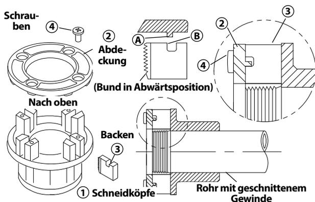
**Abbildung 12 – Einsetzen der Schneidbacken in den Schneidkopf**
