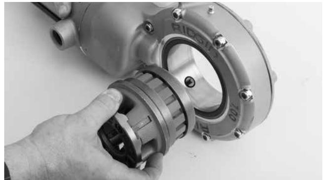
Рис. 4 – Установка резьбонарезных головок в силовой привод модели 700
