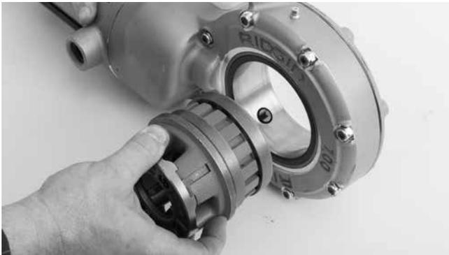
**Abbildung 4 – Einsetzen der Schneidköpfe in den Kraftantrieb 700**
