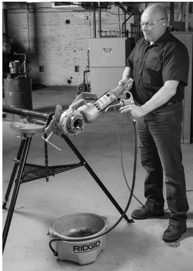
**Figur 9 – Gevindskæring af rør**
