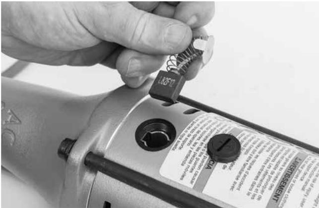
**Figura 13 – Installazione della spazzola**
