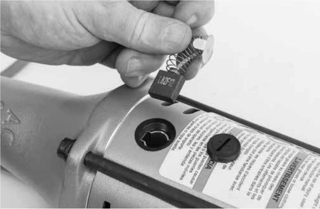
**Şekil 13 - Fırçanın Takılması**
