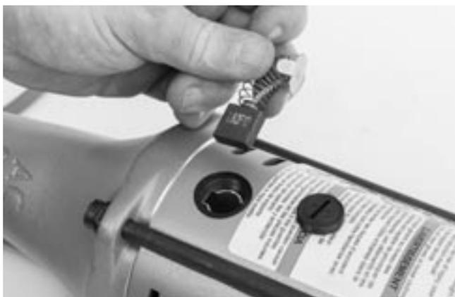
Figura 13 – Colocación de la escobilla
