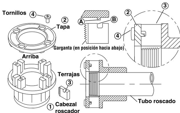
Figura 12 – Colocación de terrajas en el cabezal roscador
