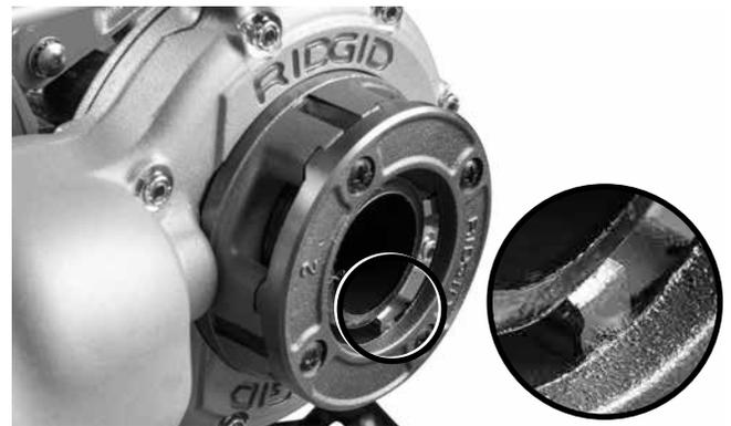
**Abbildung 10 – Rohr fluchtet mit Kante der Schneidbacken**
