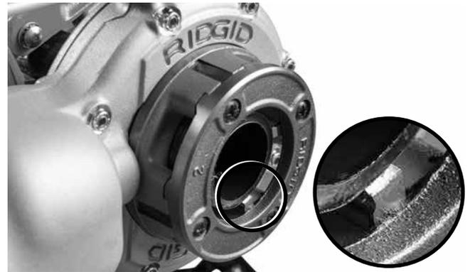
**Figuur 10 – Pijp gelijk met de rand van de snijkussens**
