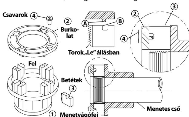
12. ábra – Menetvágók beszerelése a menetvágó fejbe
