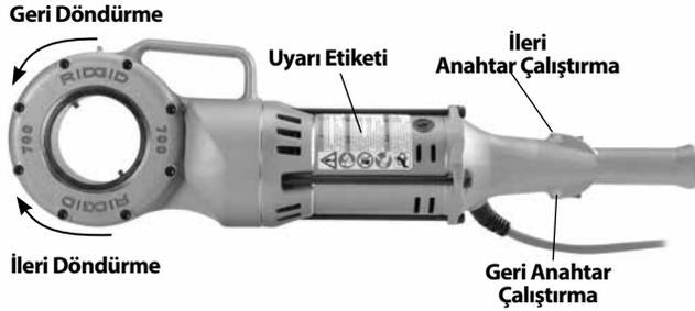
Şekil 3 – Dönüş Yönü için Anahtar Konumu
