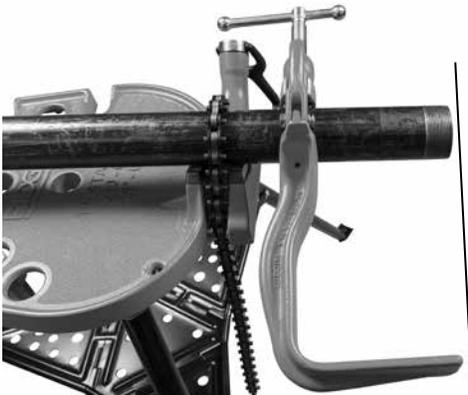
**Obrázek 5 – Podpěrné rameno zarovnané s koncem trubky**
