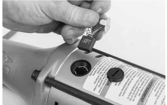
**Abbildung 13 – Einbau der Bürsten**
