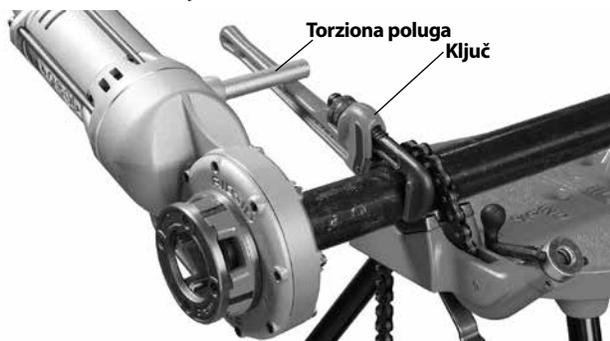
Slika 7 – Narezivanje navoja korišćenjem ključa za cevi kao potporne stegne
