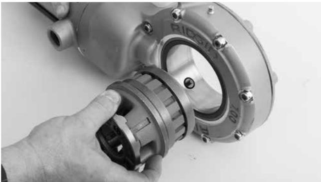
**Figuur 4 – Draadsnijkoppen aanbrengen in de Power Drive 700**
