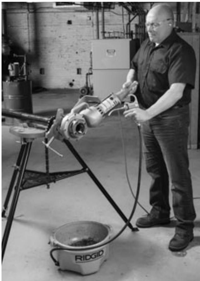
**Figure 9 – Filetage des tuyaux**
