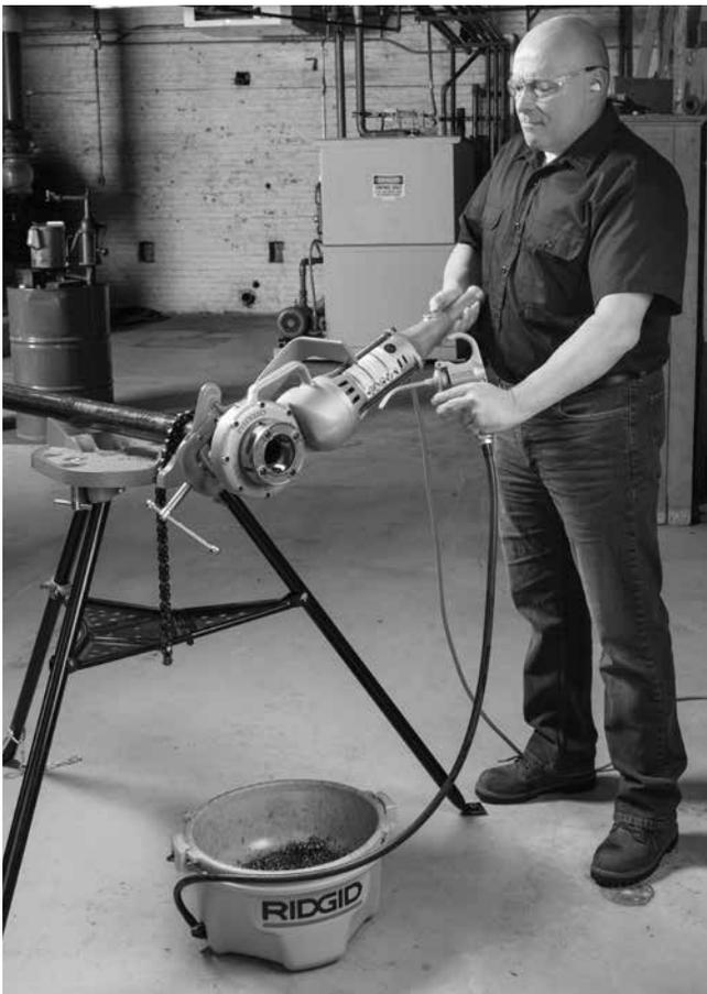
**Abbildung 9 – Gewindeschneiden in Rohr**
