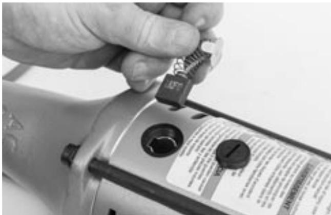
Figure 13 – Installation des balais
