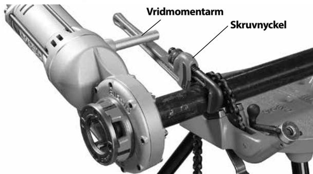
**Figur 7 – Gängning med rörtång som stödarm**
