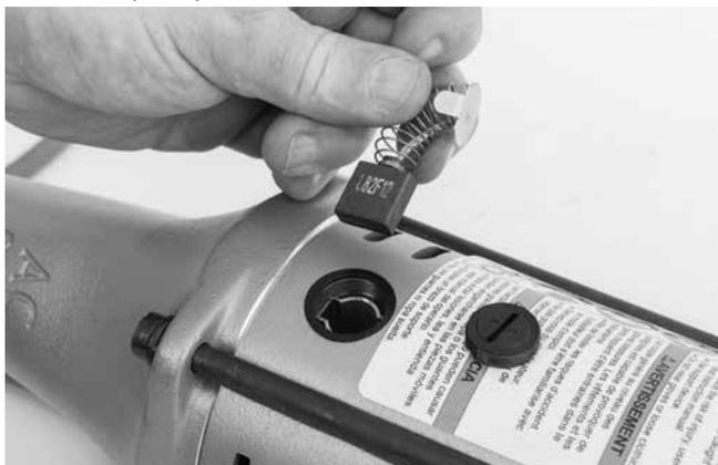
**Рис. 13 – Установка щетки**
