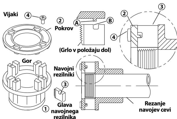
Slika 12 – Vgradnja rezalnih nastavkov v glavo
