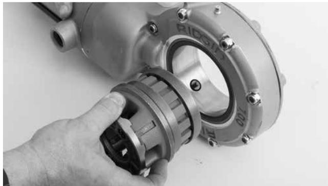
**Figura 4 – Montarea capetelor filieră în clupa electrică 700**
