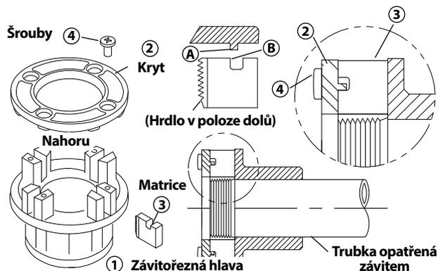
Obrázek 12 – instalace řezných matic do závitorežné hlavy
