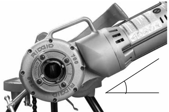
**Abbildung 6 – Stützarm positioniert, Kraftantrieb 700 leicht über der Horizontalen**
