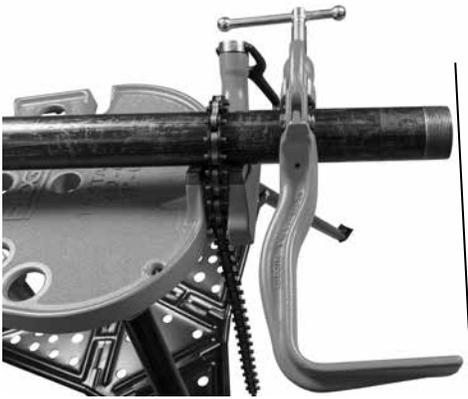
Obrázok 5 – Podporné rameno zarovnané s koncom rúry
