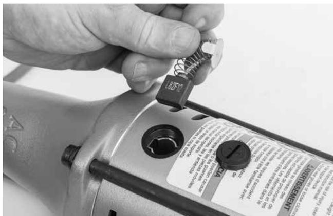
13. ábra – A kefék beszerelése
