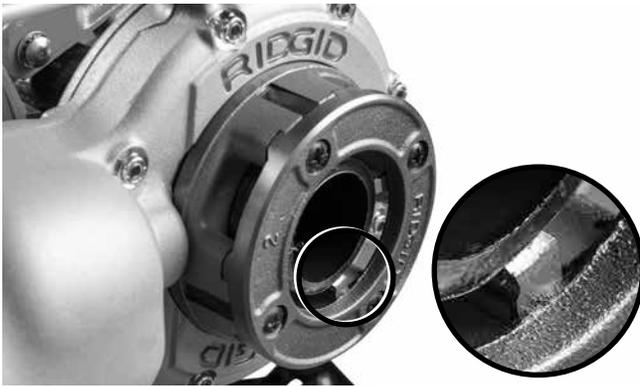
**Figura 10 – Țeava la nivel cu marginea filierelor**
