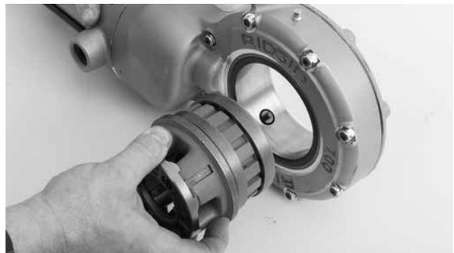
**Figura 4 – Installazione delle Teste portapettini nella Filettratrice 700**
