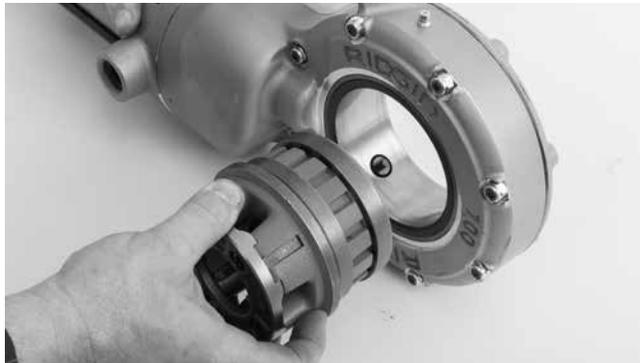
**Slika 4 – Vgradnja rezalnih glav v električni pogon 700-I**
