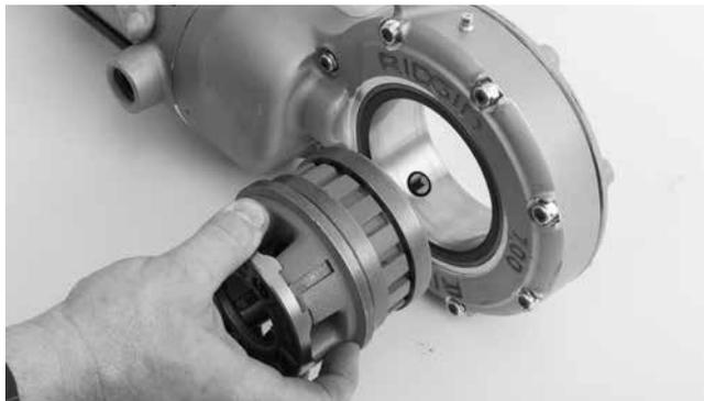
**Figur 4 – Montering af skærehoveder i det elektriske rørdrev 700**
