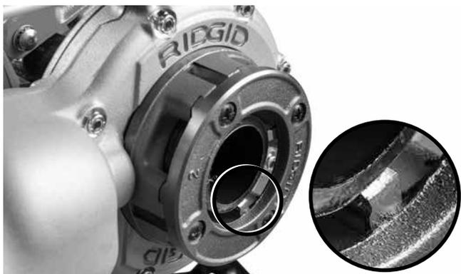
**Slika 10 – Cev je poravnana z robom rezalnih nastavkov**
