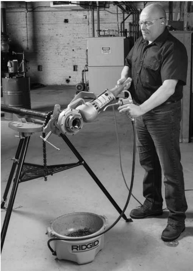
**Εικόνα 9 – Ελικοτόμηση σωλήνα**
