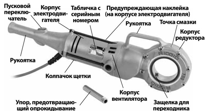
Рис. 1 – Силовой привод модели 700
