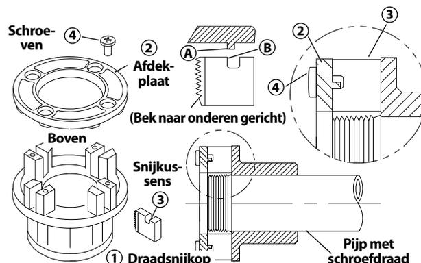
**Figuur 12 – Snijkussens aanbrengen in de draadsnijkop**
