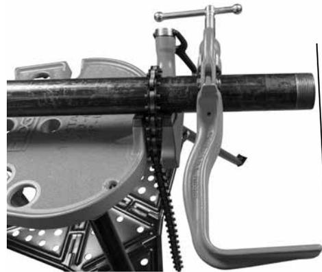
**Şekil 5 – Destek Kolu Borunun Ucu ile Hizalanmış**
