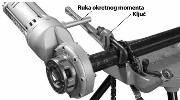
**Slika 7 – Narezivanje korištenjem ključa za cijev kako potpore ruke**
