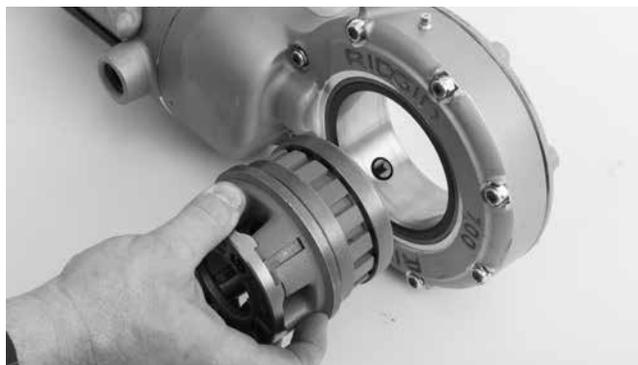
**Figur 4 – Montera gänghuvuden i drivenheten 700 Power Drive**
