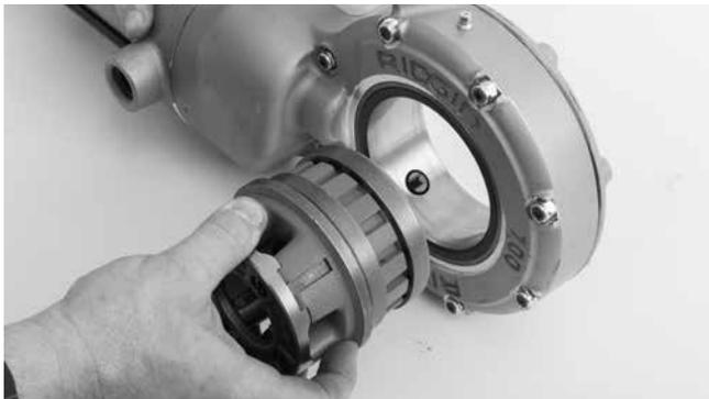
**Figur 4 – Installere gjengehoder i 700 Power Drive drivenhet**
