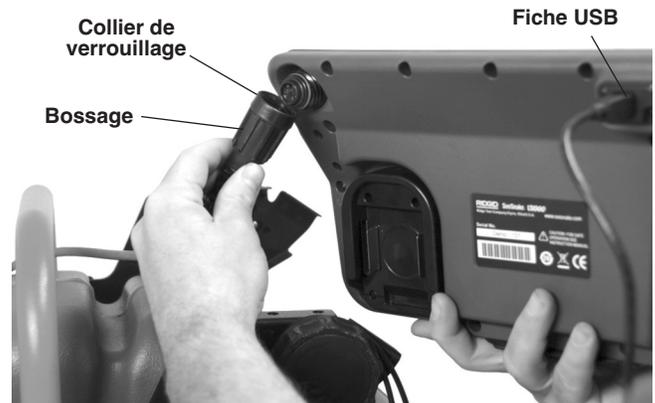
Figure 12 – Raccordement du câble de connexion SeeSnake
