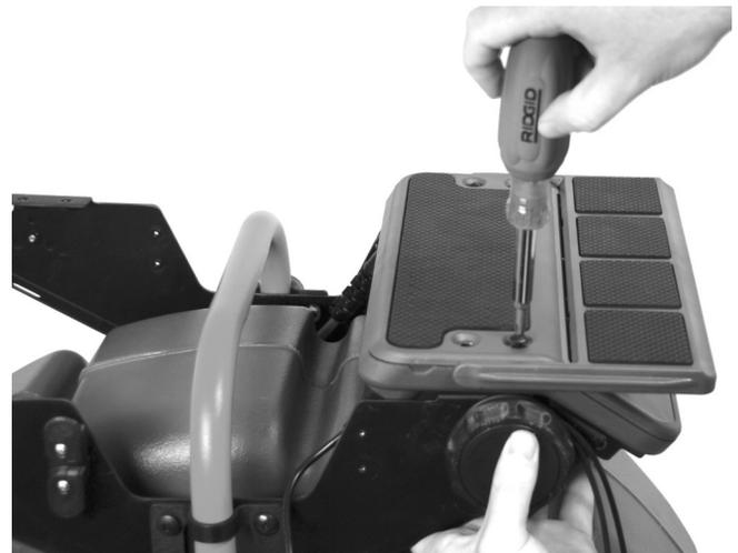
Figure 13 – Montage de la plate-forme droite
