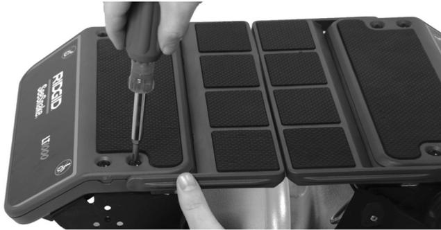
**Figure 15 – Montage de la plate-forme gauche**
