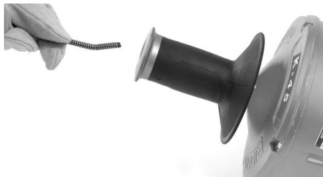
図 17—インナードラムを交換しないケーブルの収納
