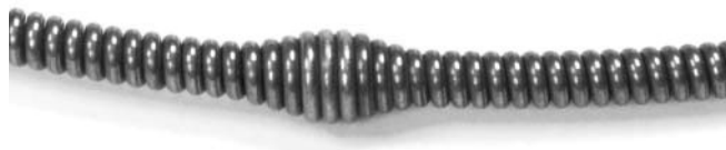
図 11—C-13-IC SB ケーブルの「スピードバンプ」 (ケーブル端から約 2.1 m)
