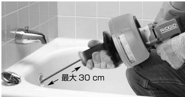
図 8—ハンドグリップをドラム側に移動してケーブルをチャックで保持
