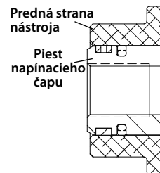
Obrázok 2 – Nízka hladina oleja dierovacej hlavy
