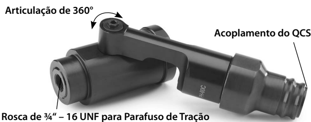
Figura 1 – Cabeça de Perfuração PH-60C Swiv-L (versão substituível)
