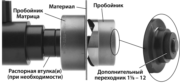
Рис. 3 – Установка перфорирующей головки
