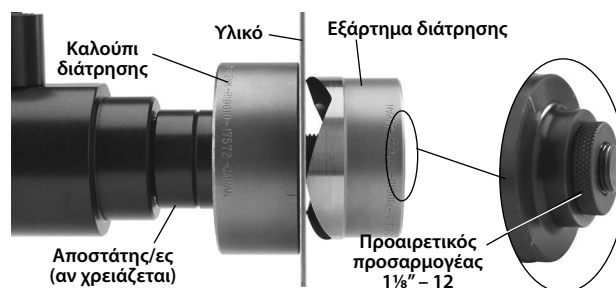
Εικόνα 3 – Τοποθέτηση της κεφαλής διάτρησης
