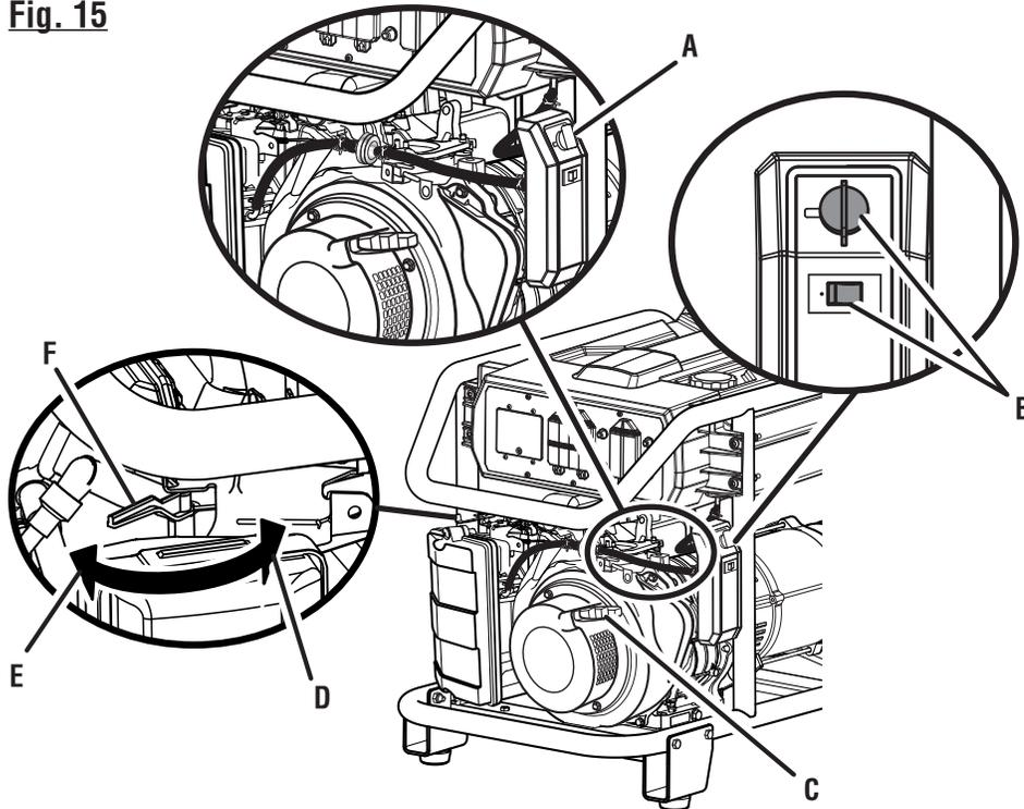
A - Fuel valve (robinet de carburant, válvula de combustible)
