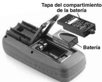
Figura 5 – Reemplazo de la batería
