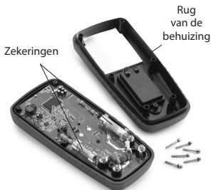
Figuur 9 – De rug van de multimeterbehuizing afnemen
