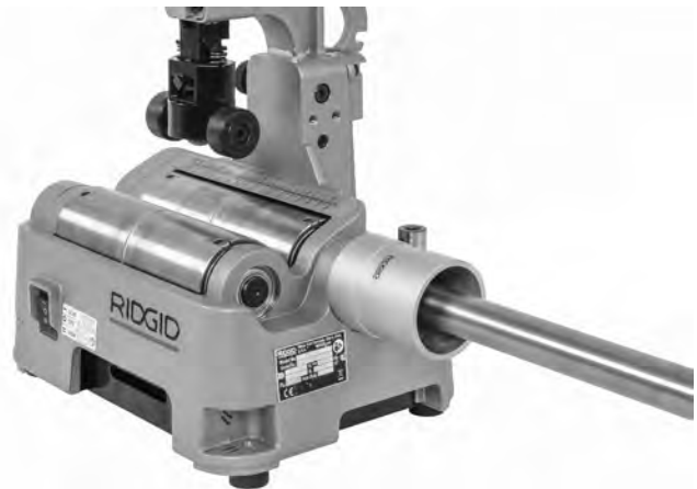
Figura 12 – Escariado del tubo
