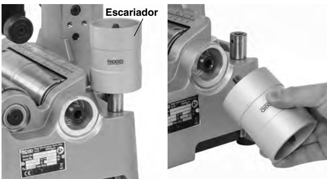
Figura 11 – Instalación del escariador
