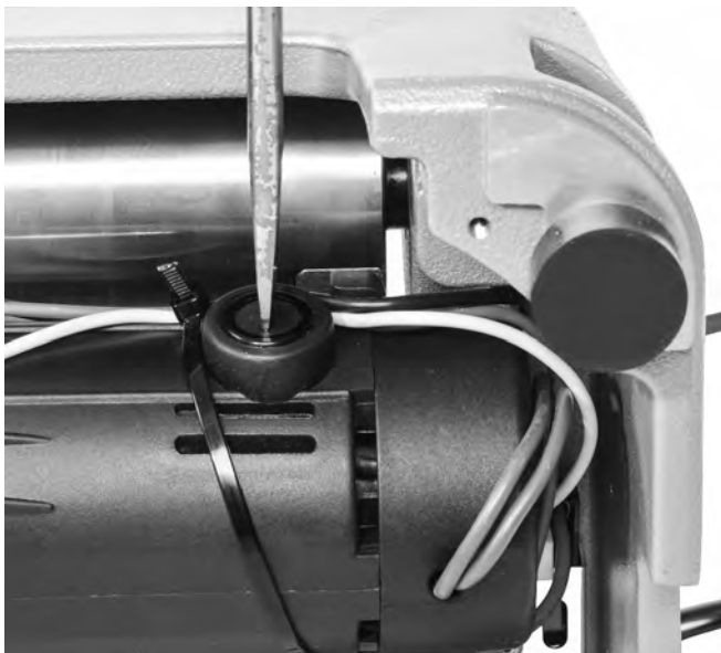
Figure 17 – Retrait des capuchons de logement de balais
