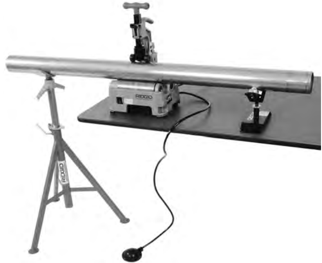
Figura 3 – Colocación del soporte
