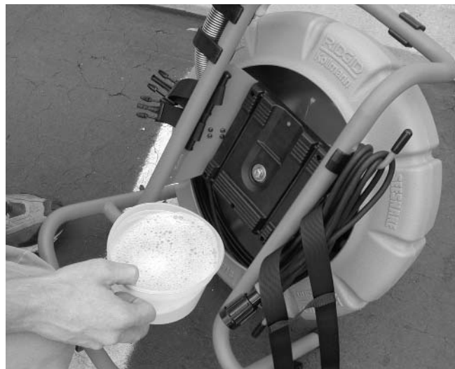
Figura 28 – Posición correcta para efectuar la limpieza
