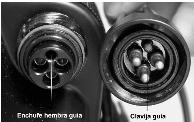
Figura 14 – Enchufe hembra guía en el conector del monitor (izquierda), clavija guía en el conector del cable
