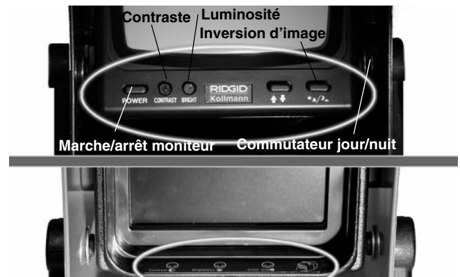
Figure 6 – Commandes des moniteurs noir et blanc (haut) et couleur (bas)
