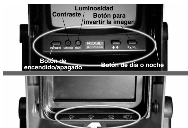
Figura 6 – (arriba) Controles de la pantalla del monitor en blanco y negro; (abajo) del monitor en colores
