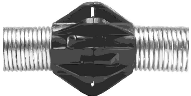
Figure 24 – Les guides de centrage améliorent la visibilité en permettant à la caméra d’assurer un balayage uniforme de toutes les parois de la canalisation, et en la maintenant surélevée par rapport aux boues du fil d’eau. Aussi réduisent-ils l’usure de la fenêtre à DEL.
