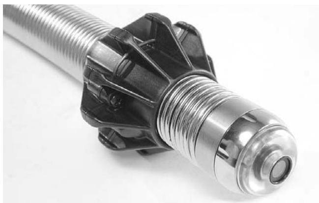
Figure 27 – Enfiler la boule de guidage sur le ressort, puis enfoncer les cerclips pour verrouiller la boule à la position voulue.
