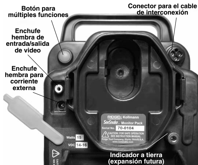
Figura 7 – Panel trasero de la unidad monitora
