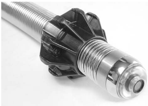
Figura 27 – Corra la guía de bola por sobre el resorte y empuje los aros de retención hacia abajo para fijar las guías en su lugar.
