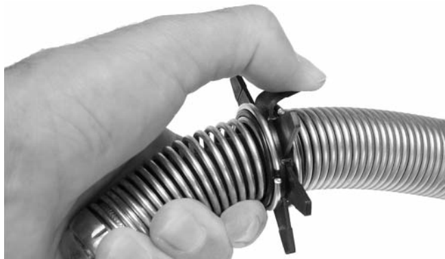
Figura 19 – Flexibilice las púas de las guías de centrado poniendo su dedo sobre la punta de cada una y luego empújelas suavemente hacia adelante y hacia atrás, en casi 90 grados. Repita en el otro sentido.
