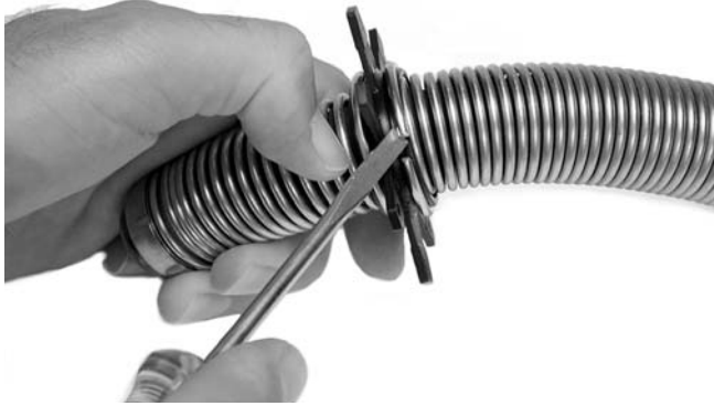
Figura 23 – Ponga la paleta plana del desatornillador entre el aro en C y la base de las púas. Haciendo palanca, levante el aro en C fuera de la ranura.
