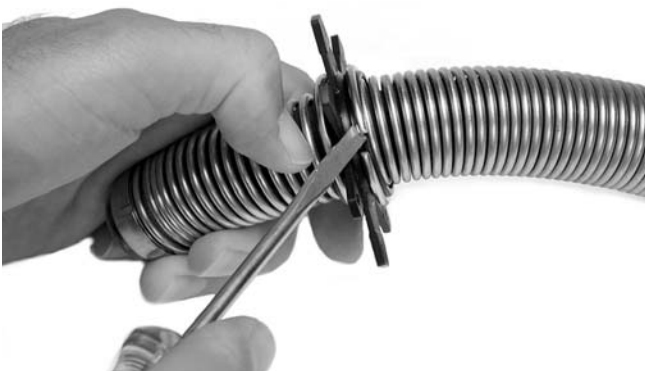
Figure 23 – Introduisez la pointe du tournevis entre le collier et la couronne du guide pour déloger le collier.
