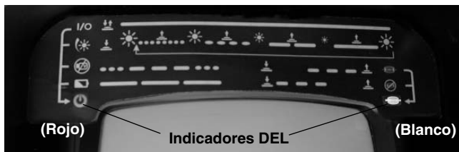
Figura 8 – Panel de los indicadores DEL
