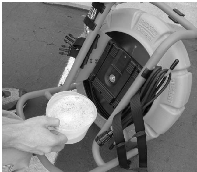
Figure 28 – Position de nettoyage appropriée
