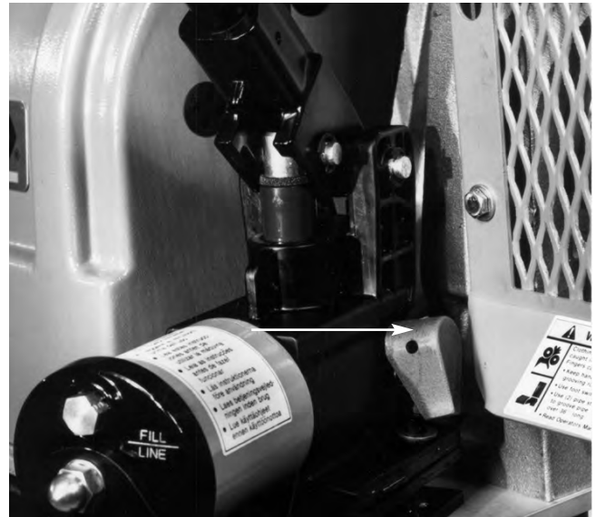
Figure 4 – Détail du levier de verrouillage de pompe de la 918-I
