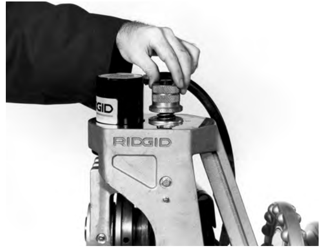
Figure 8 – Détail de la mollette de réglage de profondeur en cours de vissage contre le bâti supérieur
