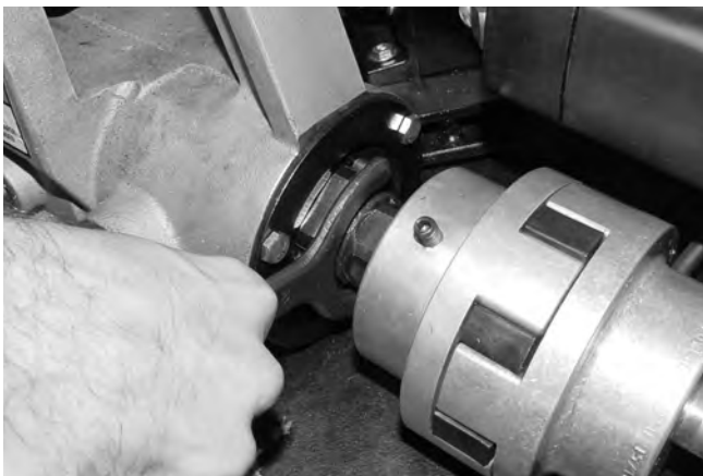
Figure 14 – Afloje y extraiga la tuerca de retención del árbol de transmisión
