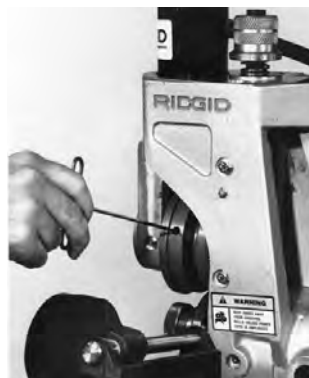
Figura 11 – Afloje el tornillo de retención en el rodillo ranurador
