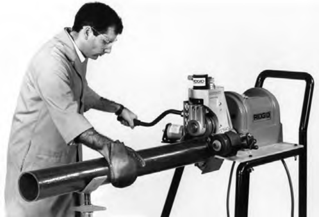
Figure 9 – Rainurage d'un tuyau en le ramenant légèrement vers soi
