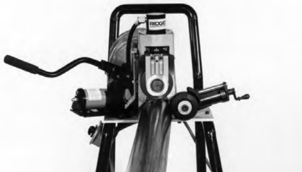
Figura 7 – Tubo desviado (exageradamente para mayor claridad) en la 918-I
