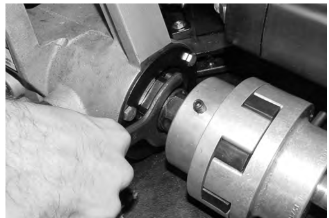
Figure 14 – Desserrage et retrait de l'écrou de retenue de l'arbre d'entraînement
