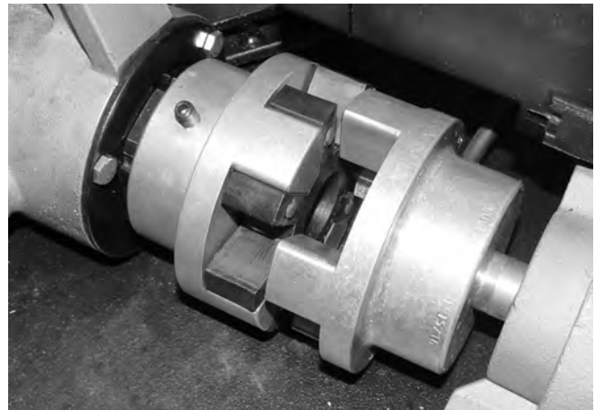
Figure 16 – Retrait de l'écrou de retenue de palier et de la partie avant du manchon d'accouplement
