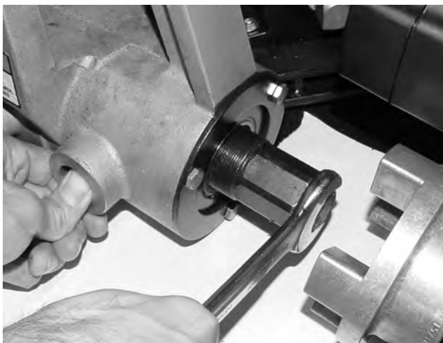
Figura 17 – Mientras se oprime el botón de enclavamiento del huso, se extrae el perno de acoplamiento del árbol de transmisión
