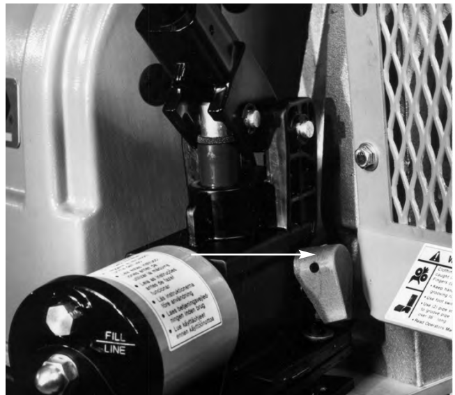
Figura 4 – Primer plano de la palanca de desenganche en la bomba de la 918-I
