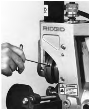
Figure 11 – Desserrage de la vis de blocage du galet de rainurage
