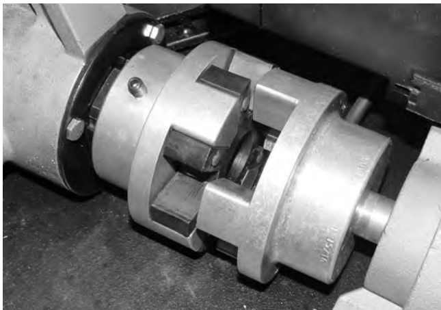
Figura 16 – Extracción del cojinete, tuerca de retención y la mitad delantera del acoplamiento
