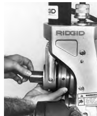
Figura 12 – Extraiga el eje del rodillo ranurador y el rodillo mismo
