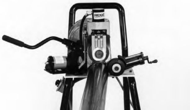
Figure 7 – Décalage du tuyau avec la 918-I (exagéré pour raisons de clarté)
