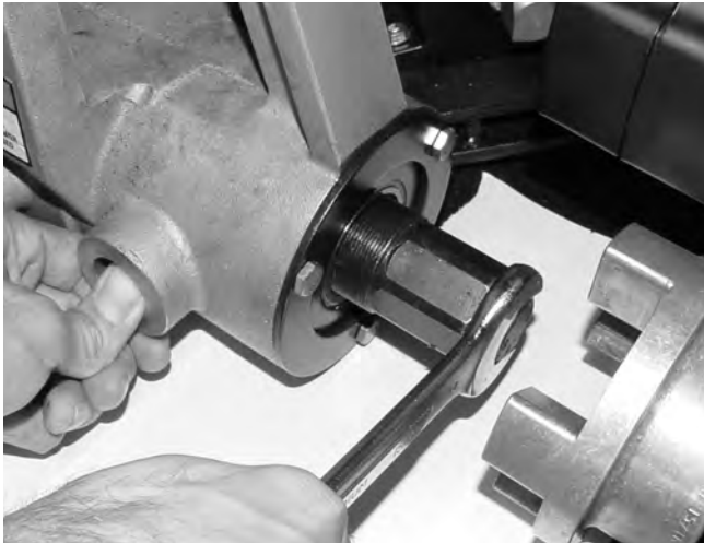
Figure 17 – Engagement de la broche de verrouillage axial et desserrage du boulon de serrage
