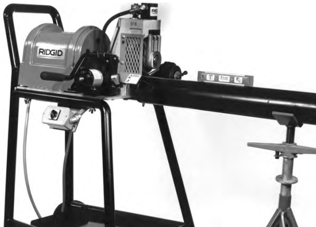
Figure 6 – Nivellement du tuyau par rapport à la 918-I à l'aide du porte-tubes
