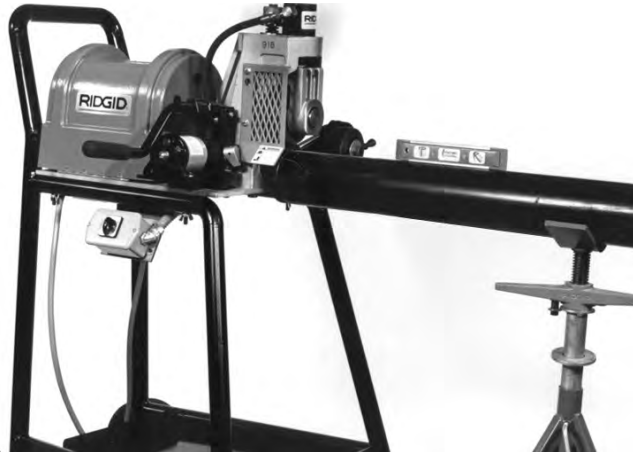
Figura 6 – Nivelación del tubo sobre el portatubos y en la Ranuradora 918-I
