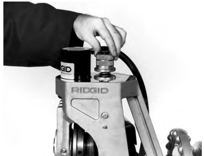
Figura 8 – Primer plano de la perilla de ajuste de la profundidad siendo apretada hacia abajo
