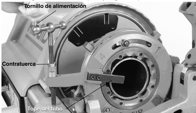
Figura 3 – Corte de una ranura en el tubo
