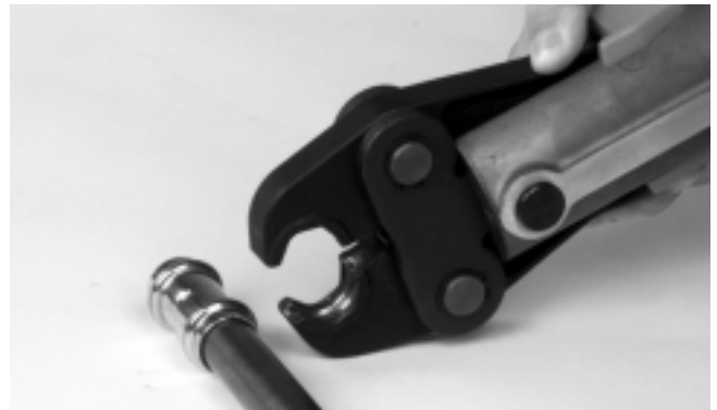
Figure 4 – Ouverture du jeu de mâchoires à ciseaux
