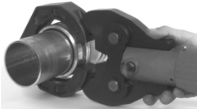
Figure 9 – Montage de l'actionneur à bagues sur la bague de sertissage
