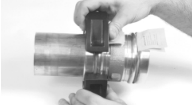
Figure 8 – Positionnement de la bague de sertissage sur le raccord
