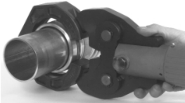
Figura 9 – Enganche del accionador del aro, en el aro sellador
