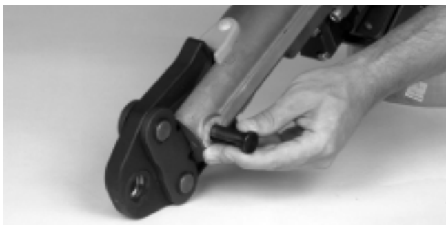
Figura 2 – Para montar las mordazas, jale el pasador
