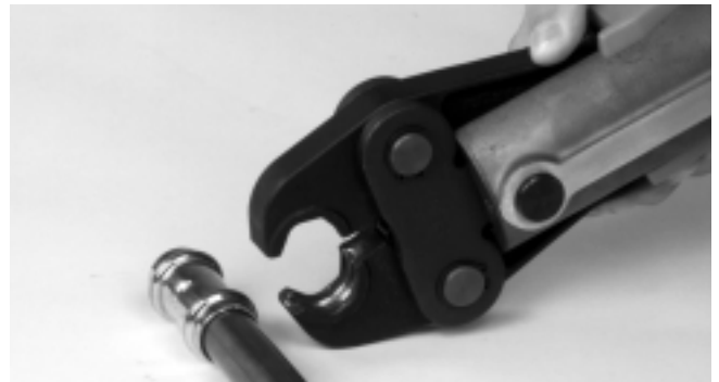
Figura 4 – Apertura de las mordazas tipo tijeras
