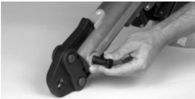
Figure 2 – Retrait de l'axe de montage du jeu de mâchoires
