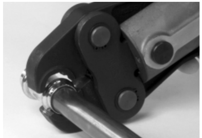
Figura 5 – Montaje de las mordazas alrededor del acoplamiento
