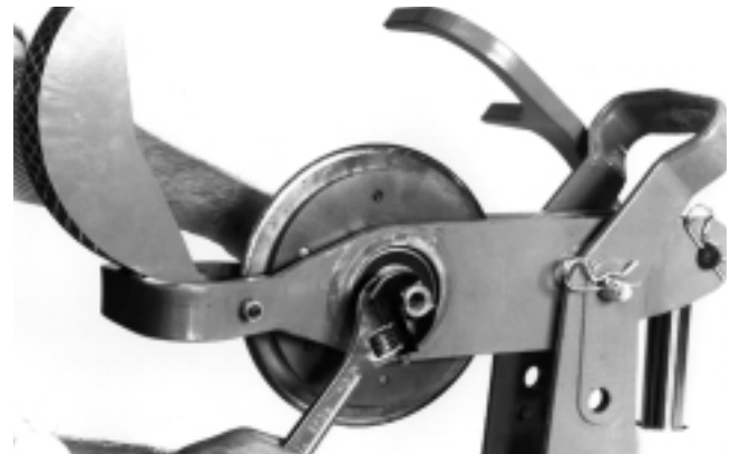
Figura 11 – Extraiga la tuerca de seguridad
