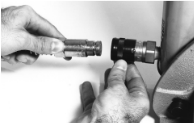
Figura 3 – Conexión de la bomba de pie hidráulica al Cortatubos
