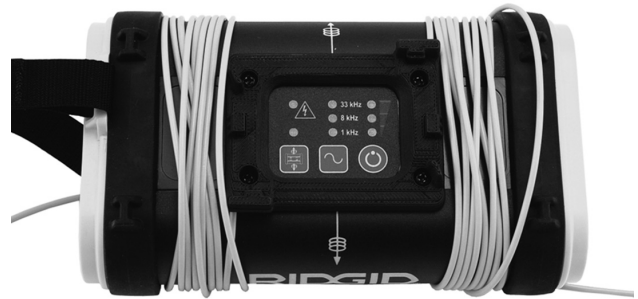
Fig. 11: ST-305 i induktiv funktionstilstand ved 33 kHz
