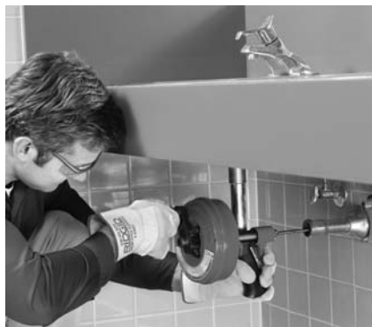
Figure 8 – Utilisation manuelle du Power-Spin
