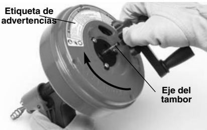
Figura 2 – Extracción de la manivela fuera del Power-Spin
