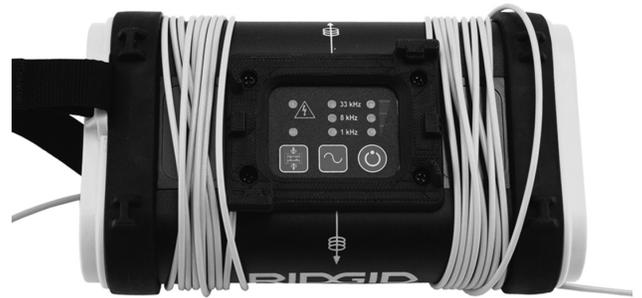
Figura 11: ST-305 en modo inductivo a 33 kHz
