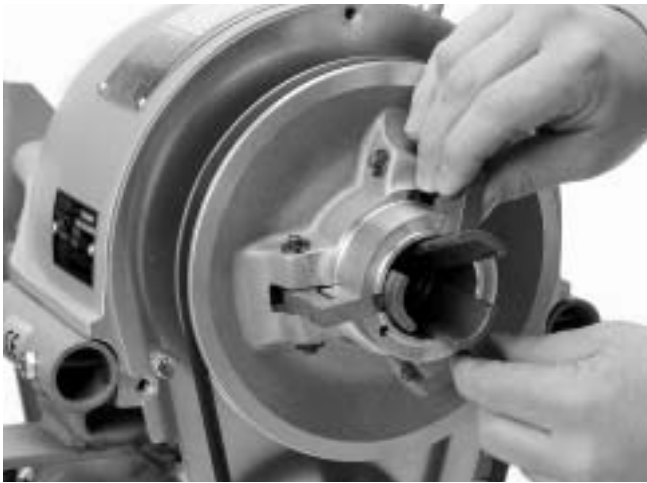
Figura 12 – Recambio de las mordazas del embrague
