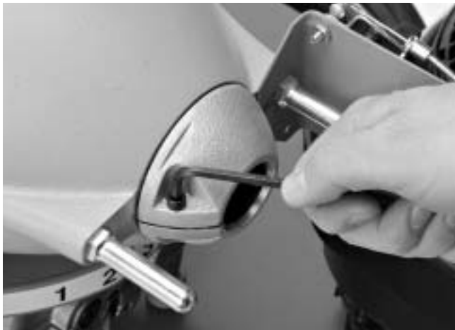
Figure 13 – Élimination du jeu axial de l'embrayage
