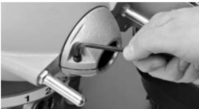
Figura 13 – Eliminación del juego (holgura) del embrague
