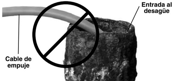
**Figura 23 – Evite dañar el cable en bordes afilados**
