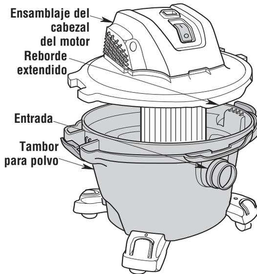
2. Presione hacia dentro sobre los dos pestillos ubicados a ambos lados del tambor para polvo hasta que se acoplen a presión en la posición correcta, sujetando firmemente el ensamblaje del cabezal del motor al tambor para polvo.
