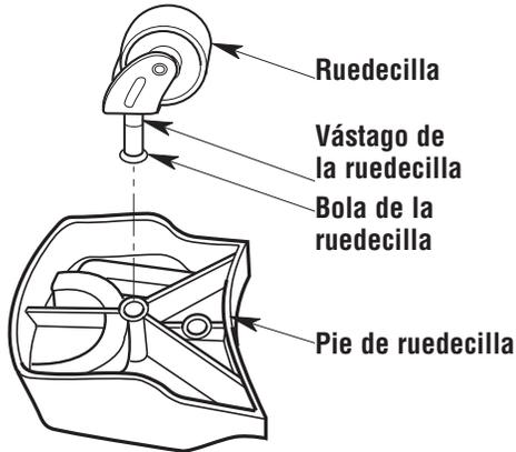
4. Coloque el pie de ruedecilla con ruedecilla sobre el poste ubicado en la parte inferior del tambor para polvo y presiónelo firmemente en la posición correcta, de la manera que se muestra en la ilustración.
