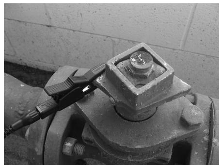
Figure 7: Connexion du ST-305 à une ligne
