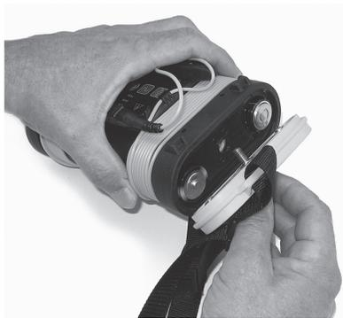
Figure 3: Retrait du couvercle du logement des piles
