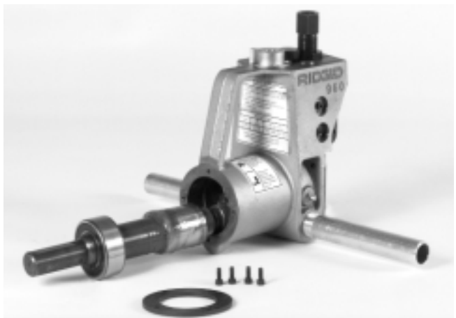
Figura 11 – Extracción del eje de accionamiento de la Ranuradora 960
