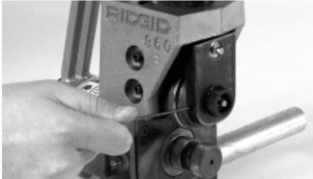
Figura 12 – Extracción del tornillo de retención fuera del rodillo ranurador
