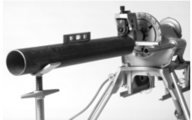
Figure 5 – Nivellement du tuyau avec la N° 960 à l'aide d'un porte-tubes
