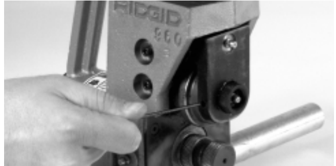
Figure 12 – Retrait de la vis de blocage du galet de rainurage
