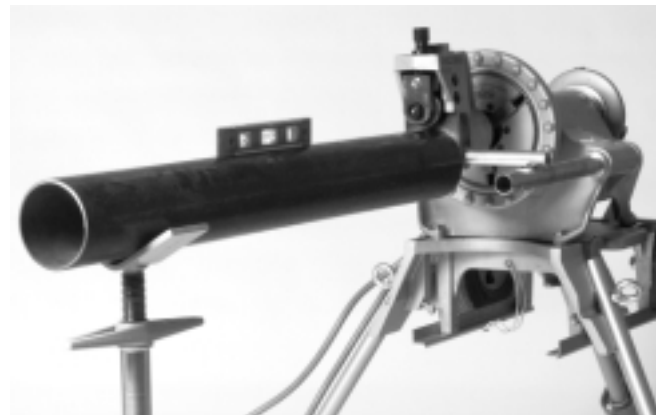
Figura 5 – Nivelación del tubo sobre el soporte y en la Ranuradora 960
