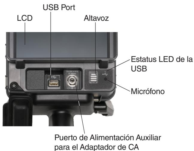
*Nota: La duración máxima de la memoria USB para que la cubierta del puerto USB cierre es de 50 mm [2 pulgadas].*
