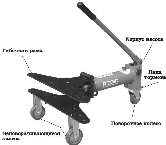
Рис. 1 – Гидравлический трубогиб с комплектом колес в сборе
