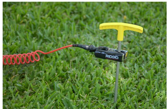
Figure 6 – Câble attaché au piquet de mise à la terre
