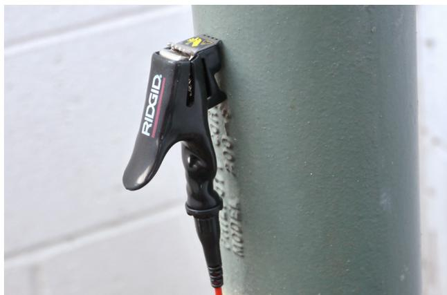
Figure 9 – Utiliser l'aimant intégré au câble pour le branchement à la cible.
