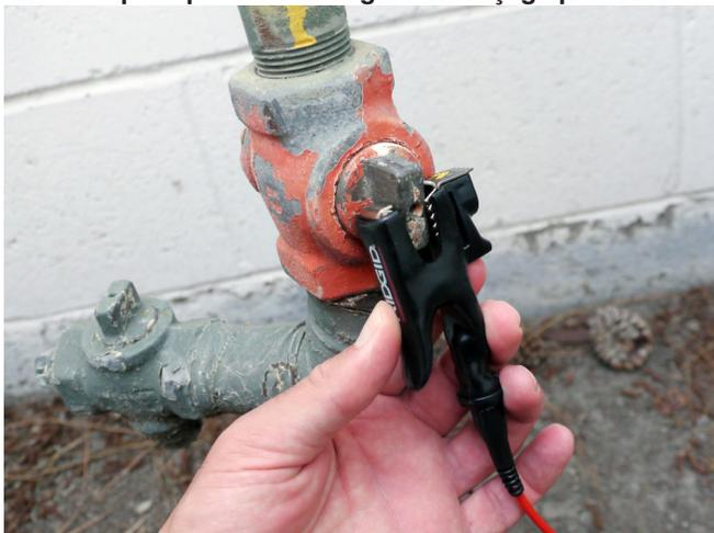
Figure 7 – Branchement du câble au conducteur cible
