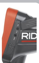
Sortie haut-parleur/microphone/casque et prise d'alimentation sur secteur
