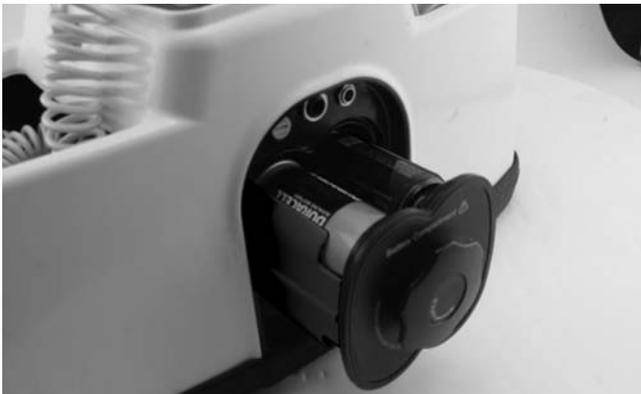
Figura 6 – Extracción de la cuna de las pilas
