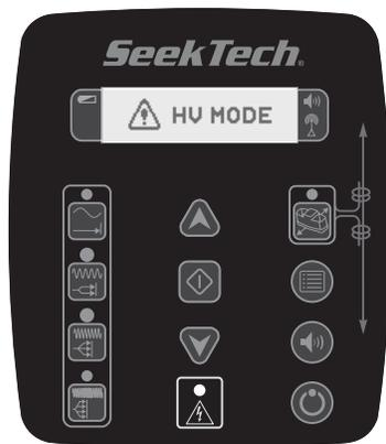
**Figura 9 – Indicador de Alto Voltaje**
