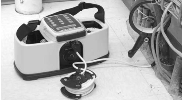
Figura 12 – Pinza inductiva ceñida a un conductor
