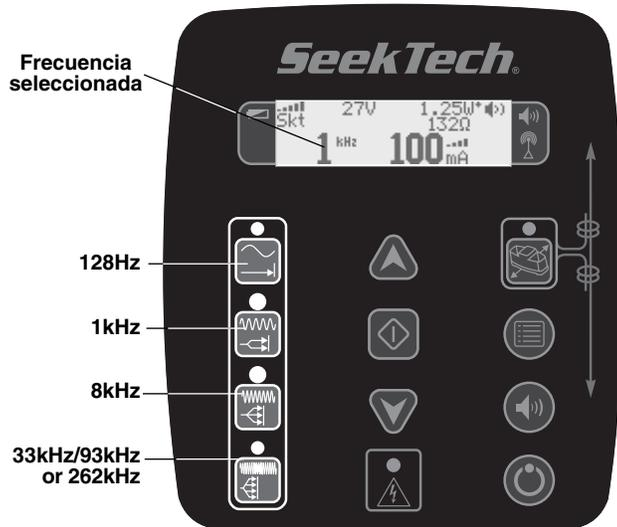
Figura 16 – Frecuencia seleccionada mostrada en pantalla
