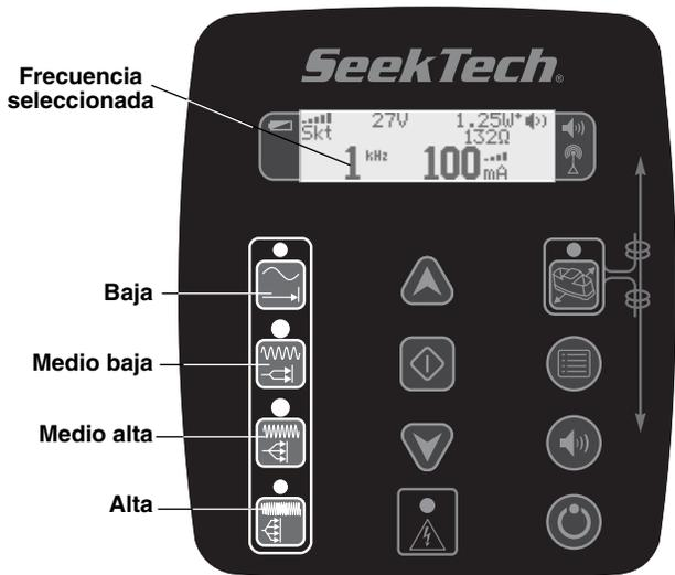
Figura 19 – Teclas de frecuencia seleccionan frecuencias para receptores/localizadores de otros fabricantes
