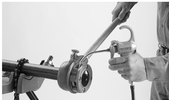
Figure 4 – Application de l'huile de coupe
