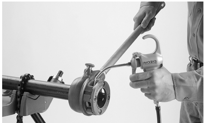
Figura 4 – Aceitado con aceite para cortar roscas
